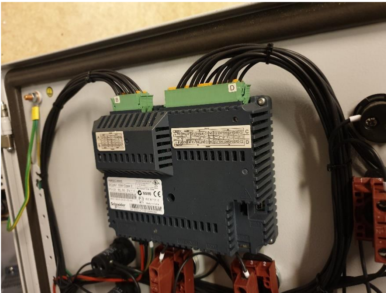
KUVA 12. Magelis SCU HMISCU6A5 -ohjelmoitava logiikka
