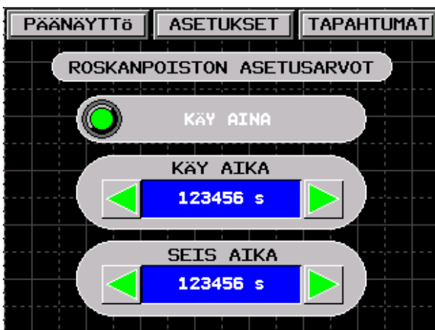
KUVA 19. Kosketusnäyttöön tehty roskaruuvin asetukset-välilehti
