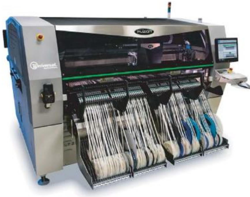
Kuva 7. Fuzion ladontakone, jonka laitevalmistaja on Universal Instruments [7]
