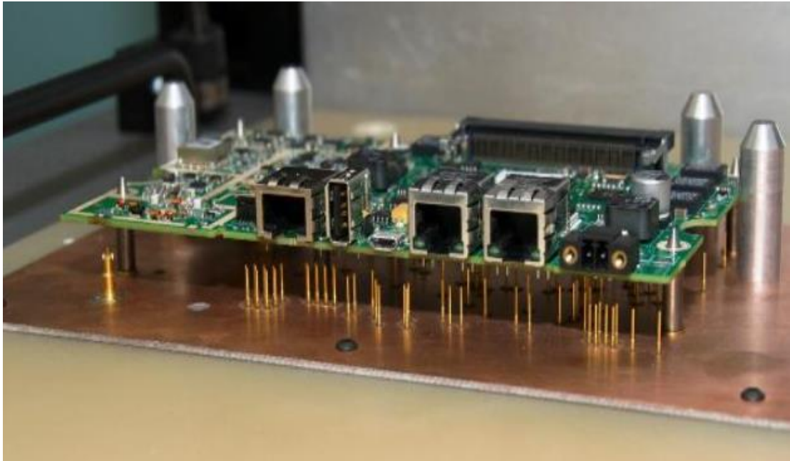
Kuva 12. Esimerkkikuva neulapedistä, jolla testataan piirikorttia [12]
