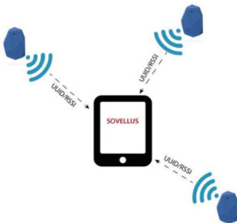
KUVA 17. Periaatekuva paikannuksesta BLE-majakoiden signaalinmittausta käyttäen
