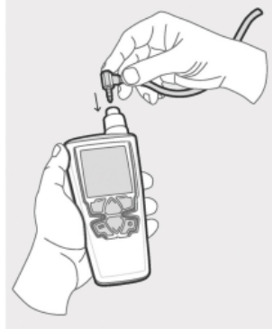
Liittimen kiinnitys HM40-näyttölaitteeseen mittaustulosten lukemista varten.
