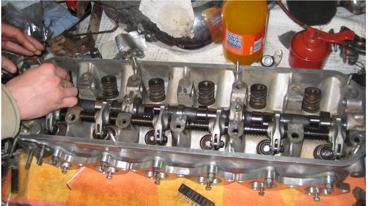
KUVA 8. Nokka-akselin, keinuvipuakseleiden sekä keinuvipujen asennus
