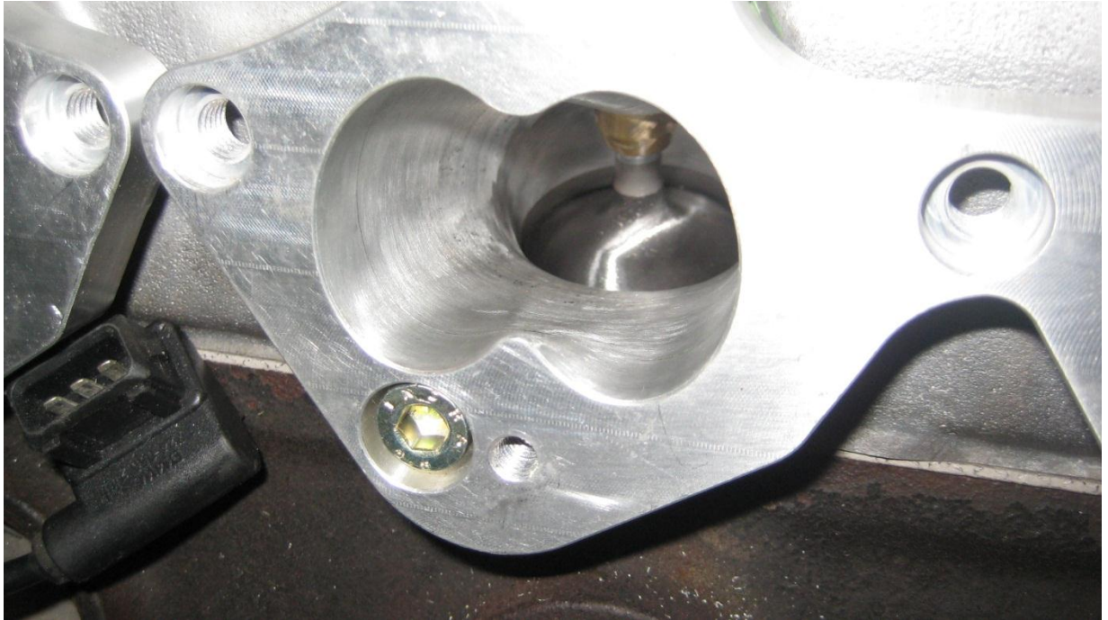
KUVA 5. Imukanavat ja läppärunkojen adapterilevyt muokattuina
