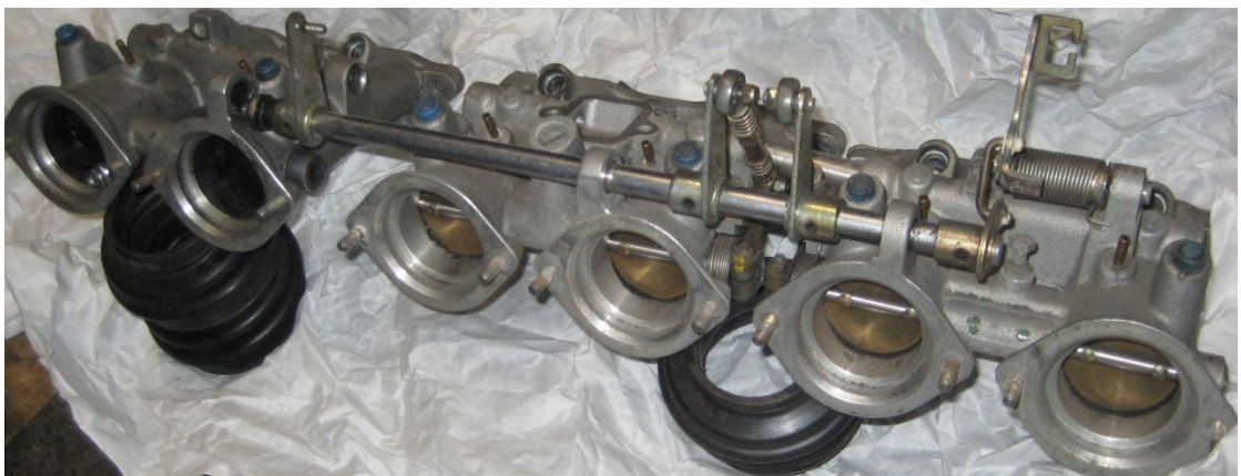
KUVA 12. Vasen läppärunkopari purettu puhdistusta varten
