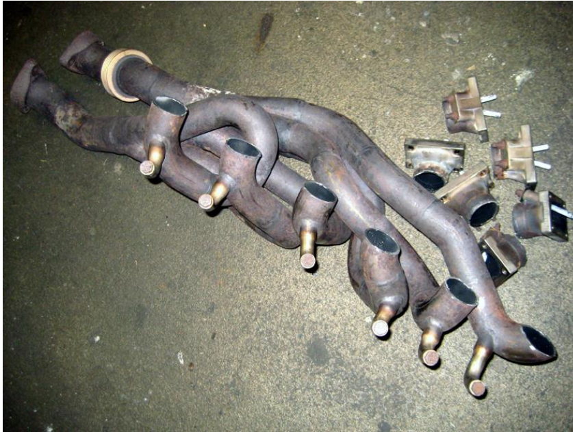
KUVA 17. Virityspakosarjat, joista alkuperäiset laipat irroitettu
