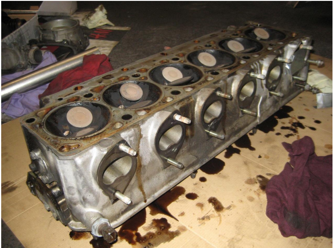
KUVA 3. Muokkaamaton sylinterikansi irroitettuna moottorista
