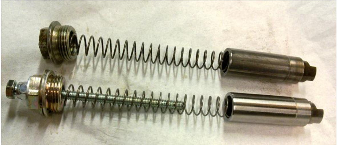
KUVA 11. Alkuperäiset ketjunkturistimen osat, joista alempana olevaan rakennettu varmistus
