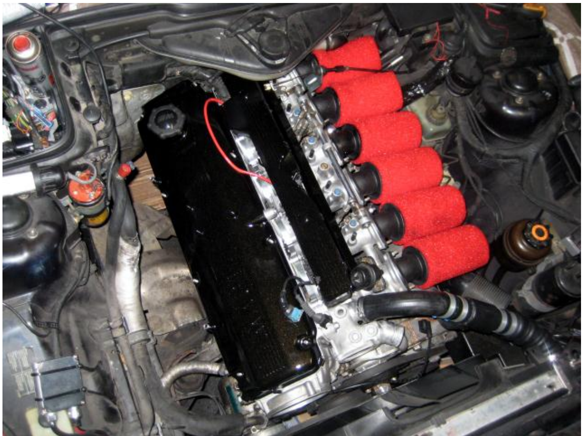
KUVA 15. Läppärungot, termostaattikotelo, imutorvet sekä imutorvisuodattimet asennettuna
