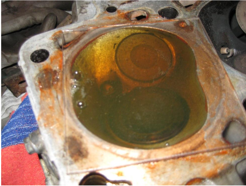
KUVA 7. Kannen palotilan tilavuuden mittaaminen
