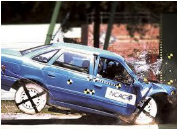
Kuva 3 Auton törmäystesti suurnopeuskameralla tallennettuna (7.)
