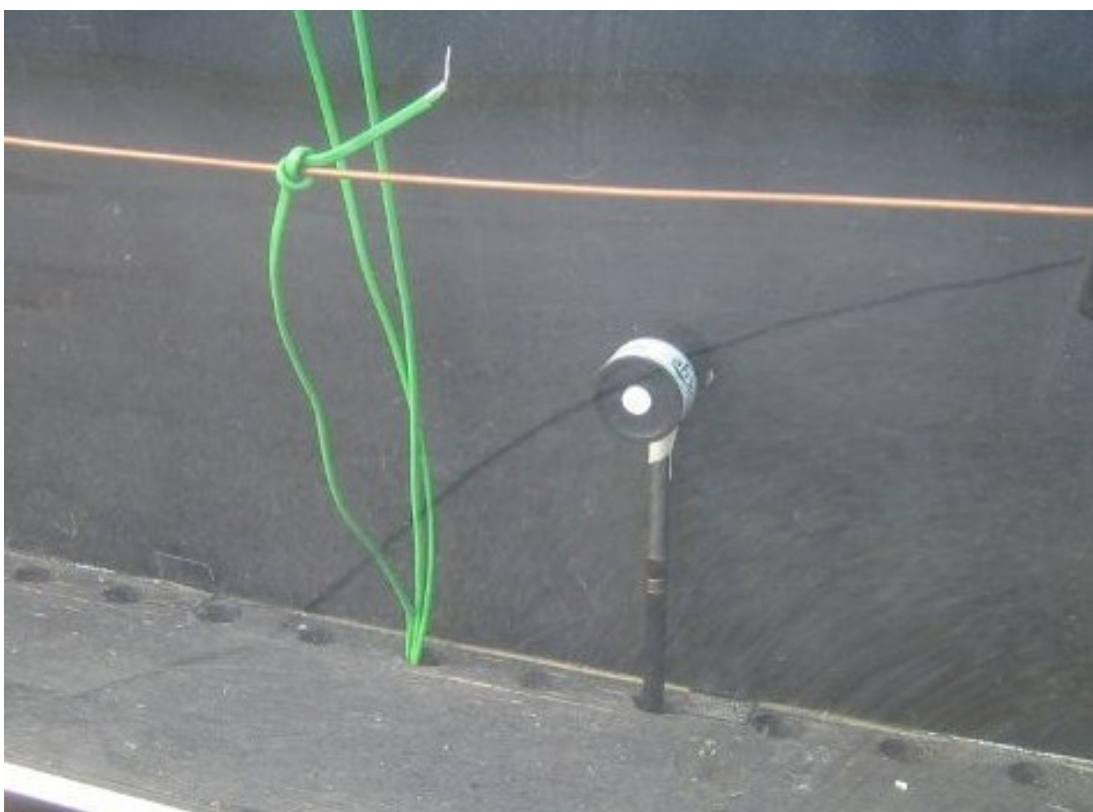
Kuva 8. Muovilevyn alapuolinen auringon säteilytehon anturi. Kuva Heikki Raunio.
