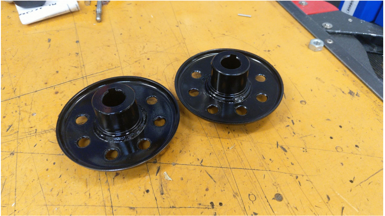
Figur 22. Hålhjulen som ska monteras på axlarna.
