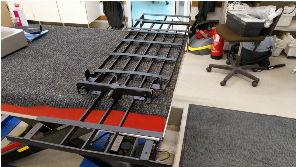
Figur 2. Ramen sett framifrån efter modifieringarna och färgning.
