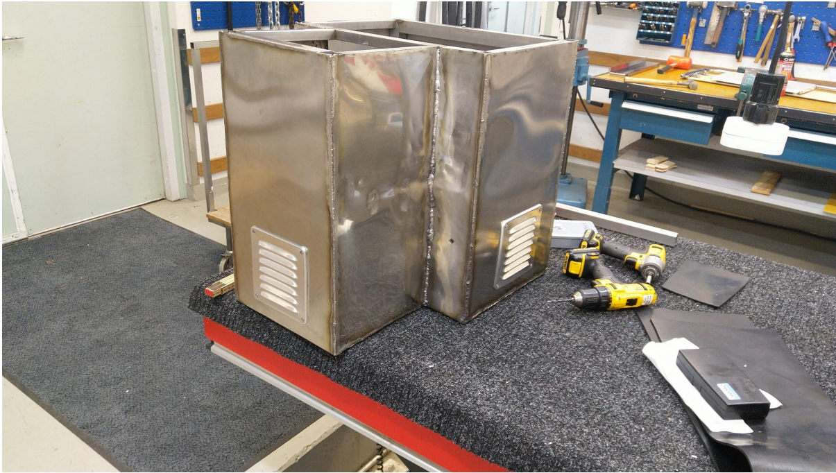
Figur 5. Bakre batterilådan med ventilationsgaller och utan lock.
