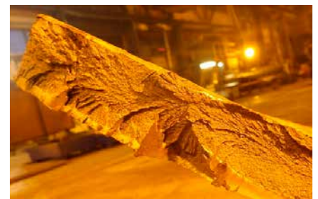
Kuva 3. Haurasta murtopintaa S355J2 tyyppisessä rakenneteräksessä.
