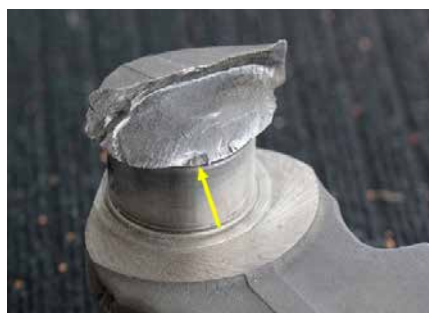
Kuva 8. Murtunut kampiakseli. Nuoli osoittaa väsymismurtuman ydintymiskohtaan.
