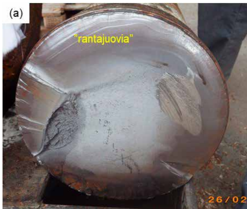
Kuva 5. Väsymismurtumia, a) meesauunin kannatinrullan akseli ja b) rataakseli.
