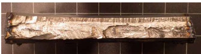
Kuva 5. Väsymismurtumia, a) meesauunin kannatinrullan akseli ja b) rataakseli.
