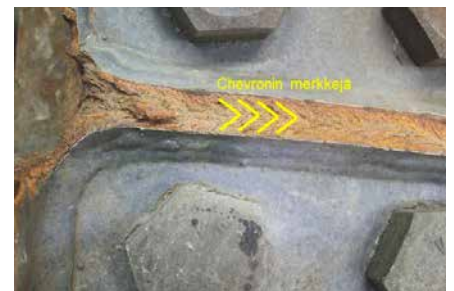
Kuva 4. ”Kersantin” merkkejä HEB-500 palkin murtopinnassa.
