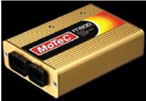
KUVA 1. MoTec moottorinohjausjärjestelmä (kilpakäyttöön)
