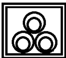
KUVA 10. Kaapelit umpinaisessa betonielementissä
