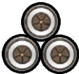
KUVA 11. Kaapelit asennettuna kolmioon (ABB)
