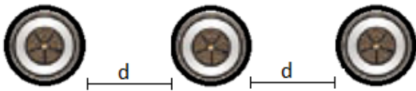
KUVA 12. Kaapelit asennettuna tasoon. Lähde (ABB) mukailen
