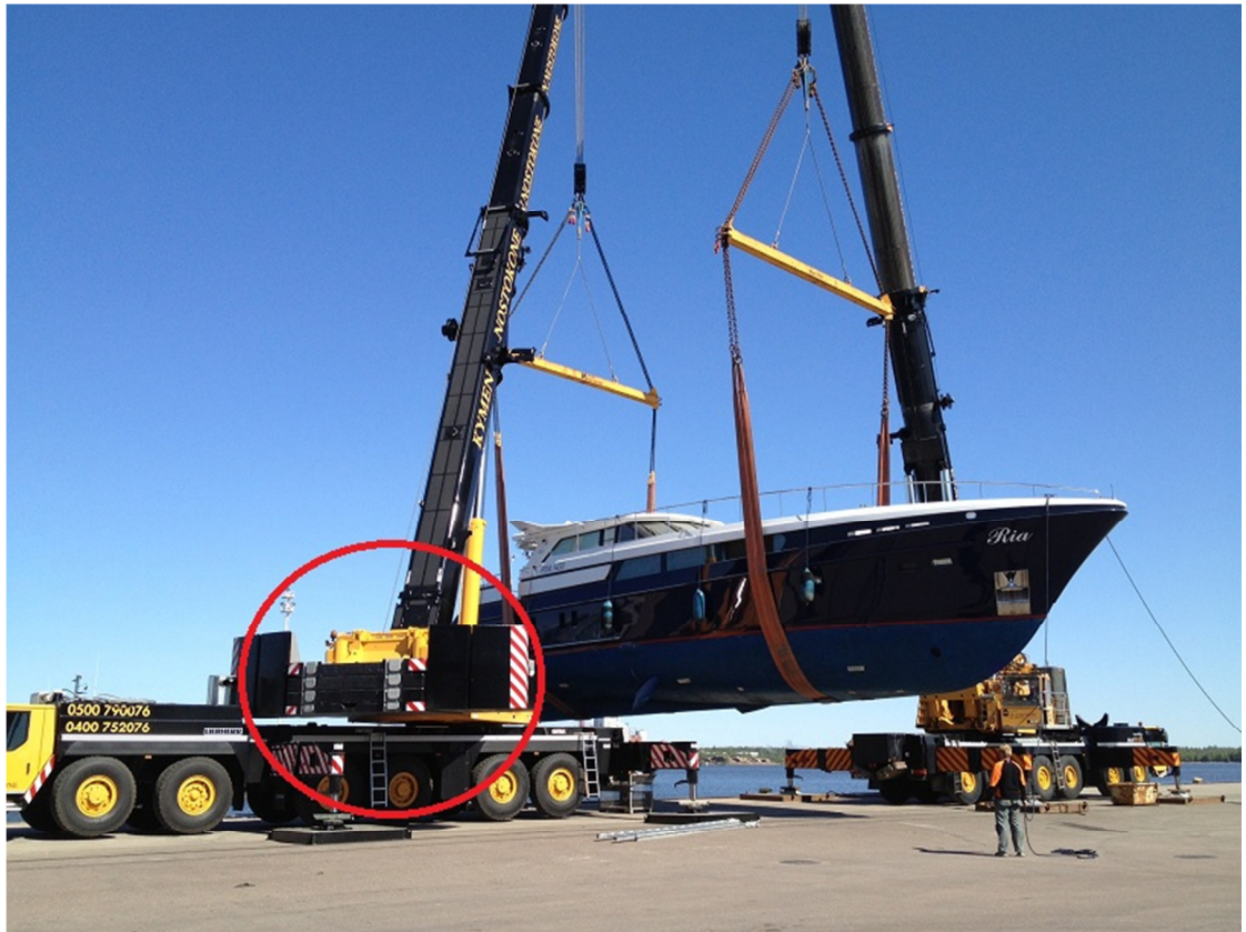
KUVA 5. LTM 1250-6.1 varustettuna 97 500kg vastapainoilla (ympyröity punaisella).
