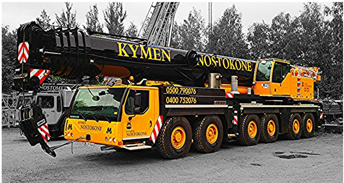
KUVA 4. LTM 1250-6.1 siirtovalmiudessa ilman vastapainoja.
