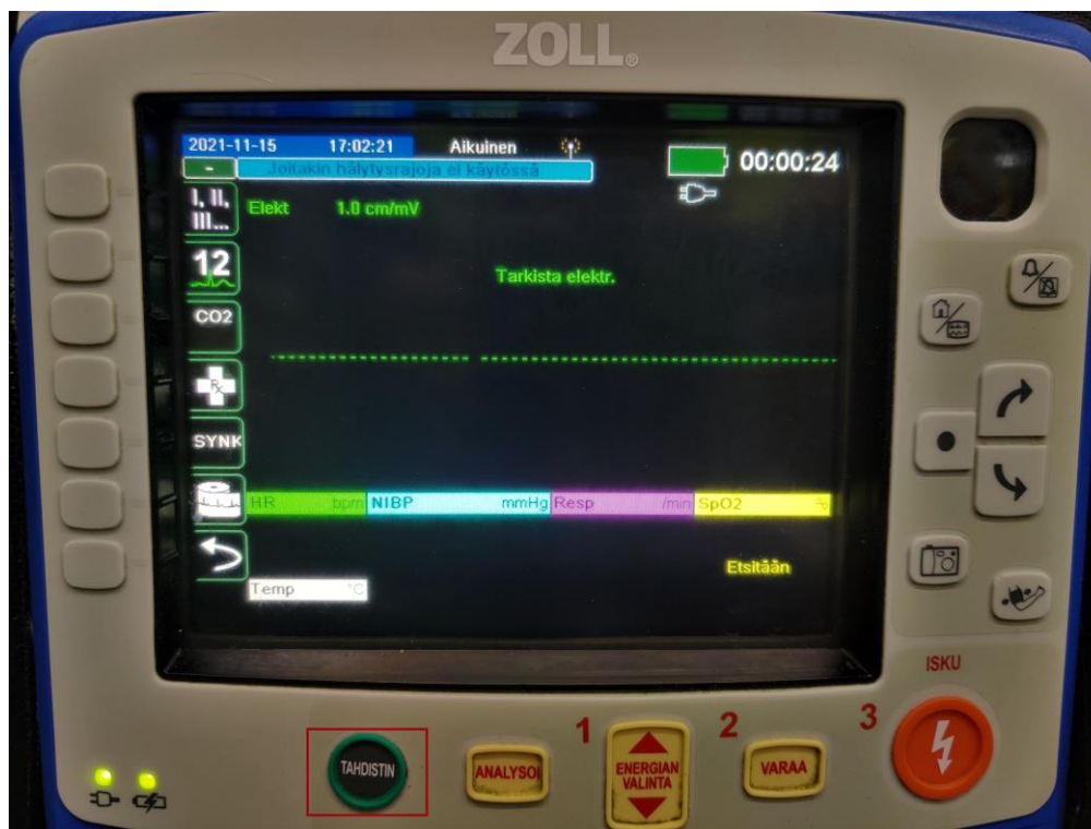
KUVA 6. Tahdistinyksikön aktivoiminen Zoll X Series -monitoridefibrillaattorissa.
