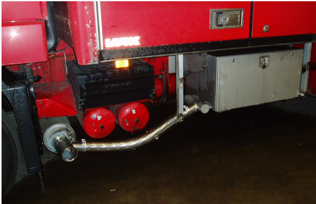
Kuva 3. Kuivaavan liinalaatikon prototyyppi asennettuna kuorma-autoon (kuvannut Kristian Lindfors).
