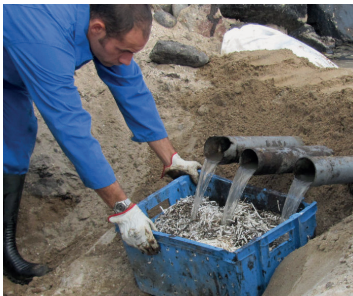
Kuva 9.11 Absorboivia suodattimia voidaan rakentaa helposti itse. Absorboivia puomeja voidaan rakentaa kanaverkosta ja absorboivasta materiaalista ja suodattimen tehdä rei’itetystä korista, jossa on absorboivaa materiaalia (M. Pascale 2010).
