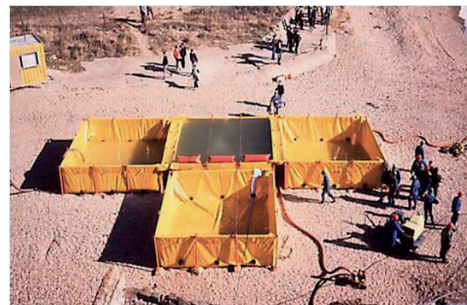
Kuva 11.6 Lokeroidut altaat soveltuvat jatkuvaan dekantoimiseen, mallissa TMB (4 x 35 m 3 ) on altaan alareunassa automaattisesti avautuvat aukot, joista pääsee valumaan kevyemmin öljyinen vesifaasi toiseen altaaseen (Cedre).
