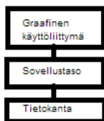
KUVA 4: Graafisen käyttöliittymän kautta ollaan yhteydessä sovellustasoon, joka toimii tietokantaa vasten.
