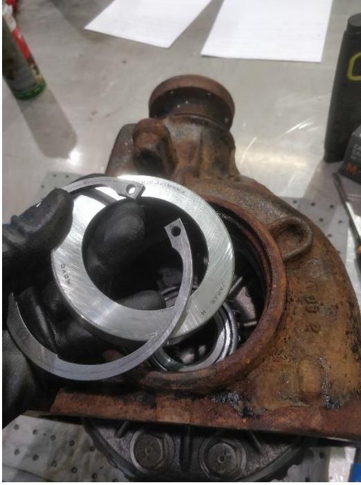
Kuva 7 Havainnollistava kuva tasauspyörästä merkittävistä osista
