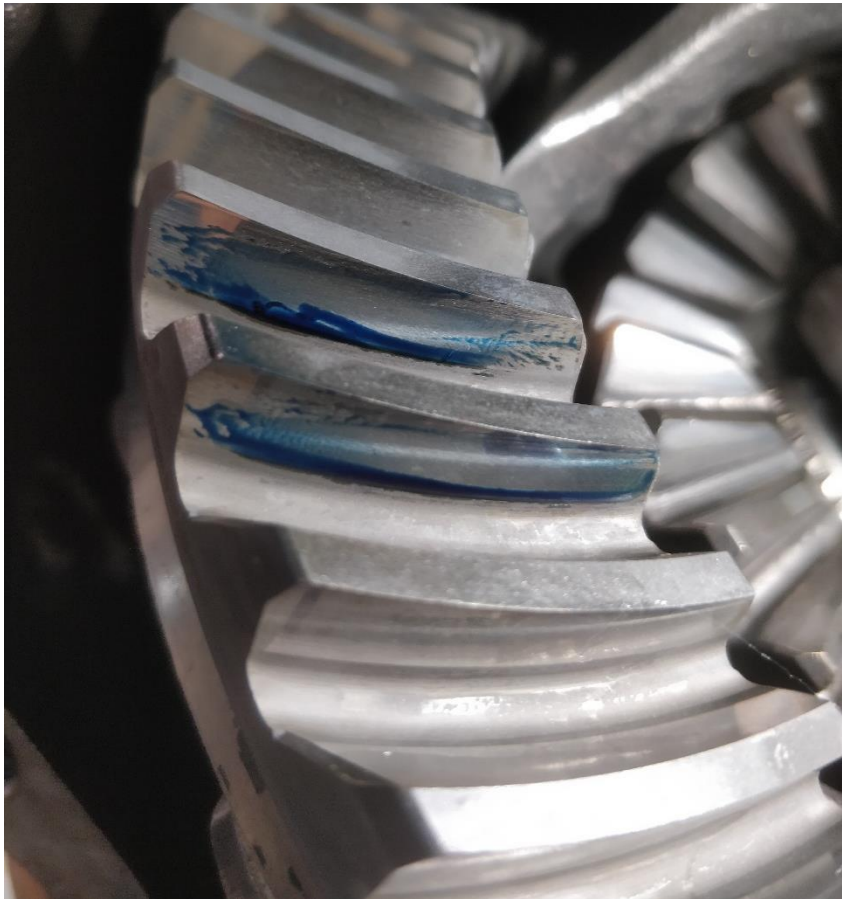
Kuva 3 Sovitevärillä tarkastettu hammaskosketus hammaspyörässä
