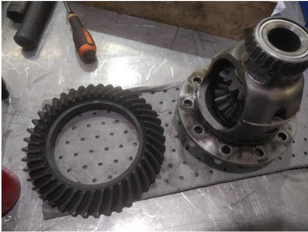
Kuva 8 Irrotettu tasauspyörästä ja lautaspöörä
