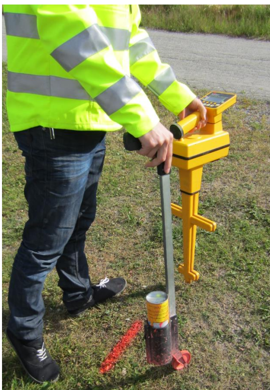
KUVA 1. Kaapelitutkalla etsitään maanalaiset kaapelit (sunet.fi).
