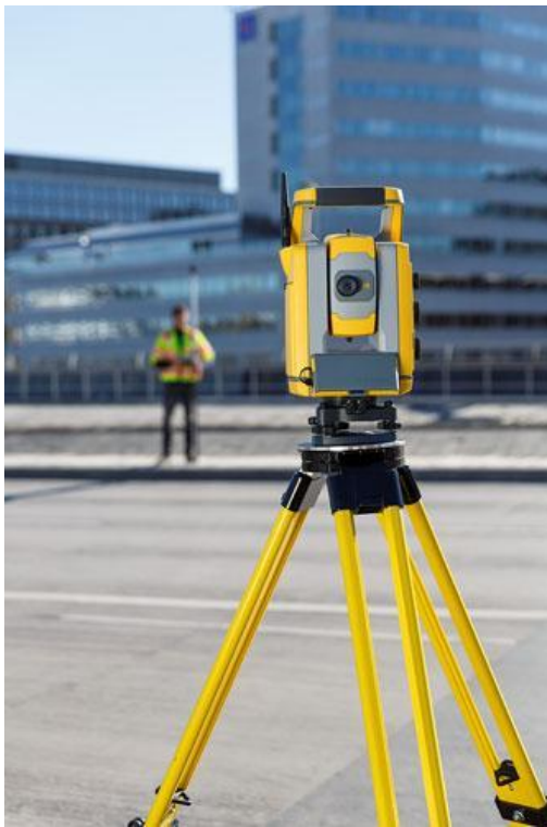
KUVA 20. Robottitakymetri maastomittaukseen (geotrim.fi).
