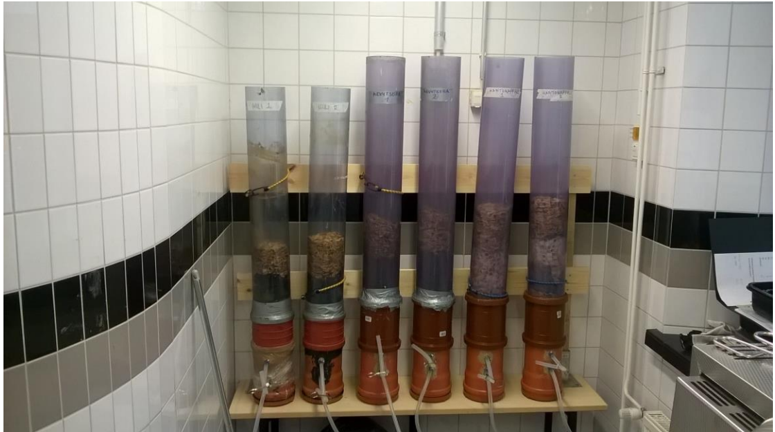
KUVA 10. Ensimmäisen vaiheen kolonnit ovat rivissä. Vasemmalta lukien täyteenä on hiiltä, kevytsoraa ja muovisia kantokappaleita (Salo 2015).
