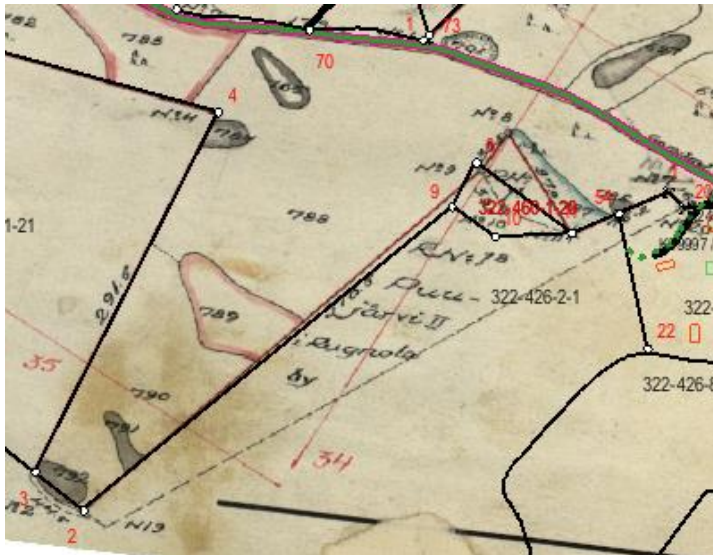
Figur 21. Exempel på en inpassning av gammal förrättningskarta. På kartan syns både fastighetsregisterkartans rålinjer och linjerna från förrättningskartan. (skärmlapp från JAKOkii)
