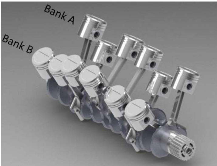
Figur 1, Exempel på hur kolvar med vevstakar är fästa till vevaxel i V12 formation (Syed Maaz Shahid, 2019).
