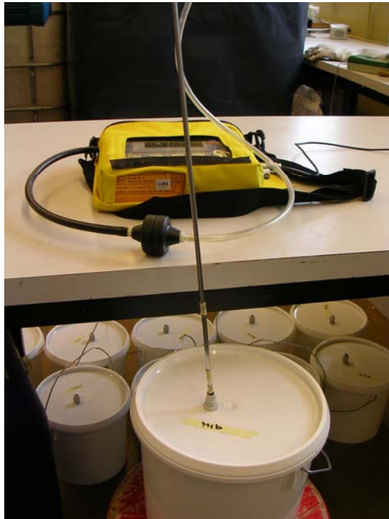
Kuva 16. Hiilidioksidin mittaus näytesangosta kaasuanalyssaattorilla
