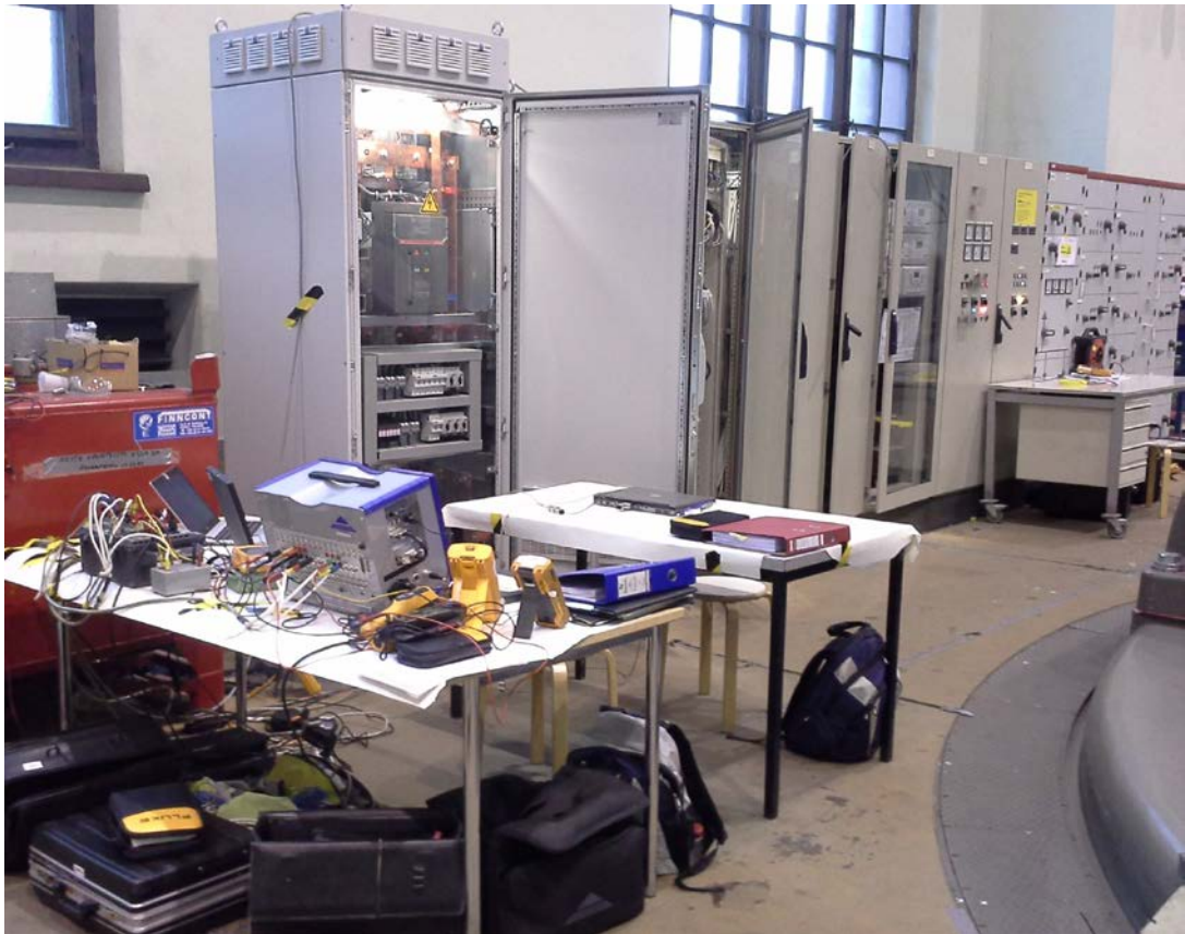
KUVA 22. Magnetointijärjestelmän käyttöönottomittausten mittausjärjestelyt
