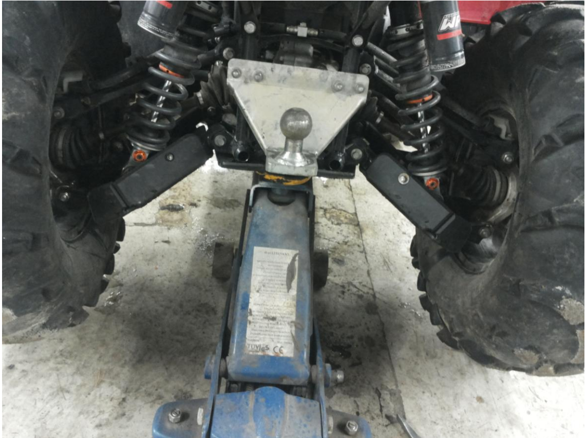
KUVA 4. Mönkijä nostettu tarkastusta varten (Asikainen 2015).
