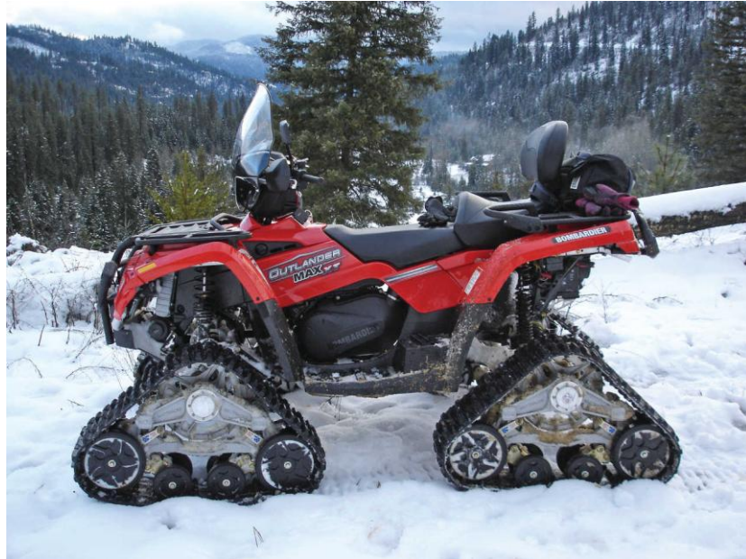
KUVA 7 Mönkijä teloilla varustettuna (ATV&SXS Illustrated 2015)
