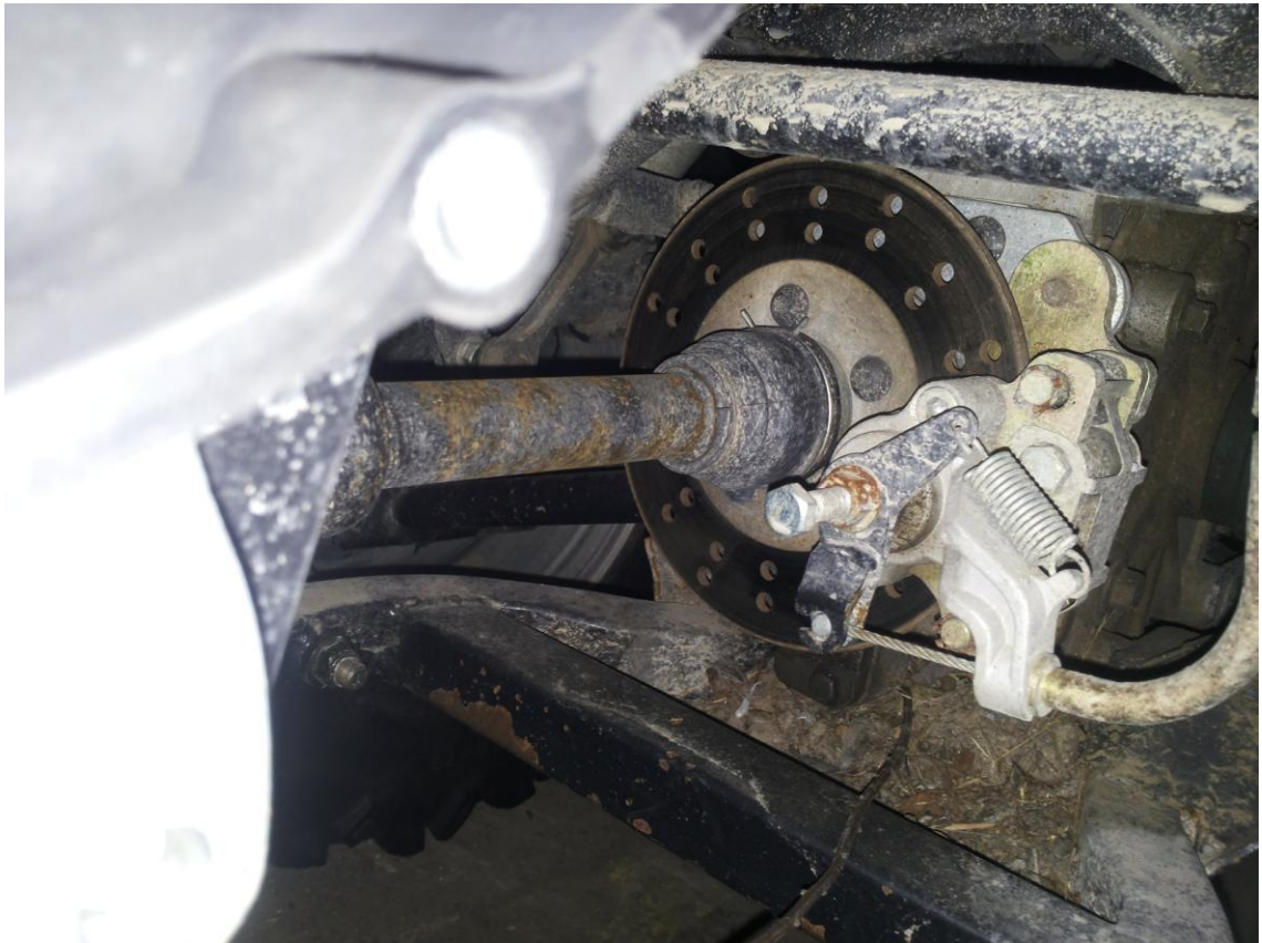
KUVA 2. Kardaanikäsijarru, vaijeri käyttöisenä (Asikainen 2015).
