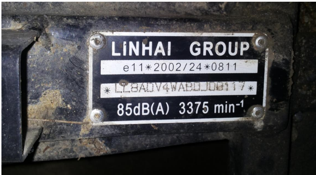
KUVA 2. Kuva valmistajan kilvestä, josta selviää valmistaja, tyyppihyväksyntä numero, valmistenumero sekä äänitaso tietyillä kierroksilla (Asikainen 2015).
