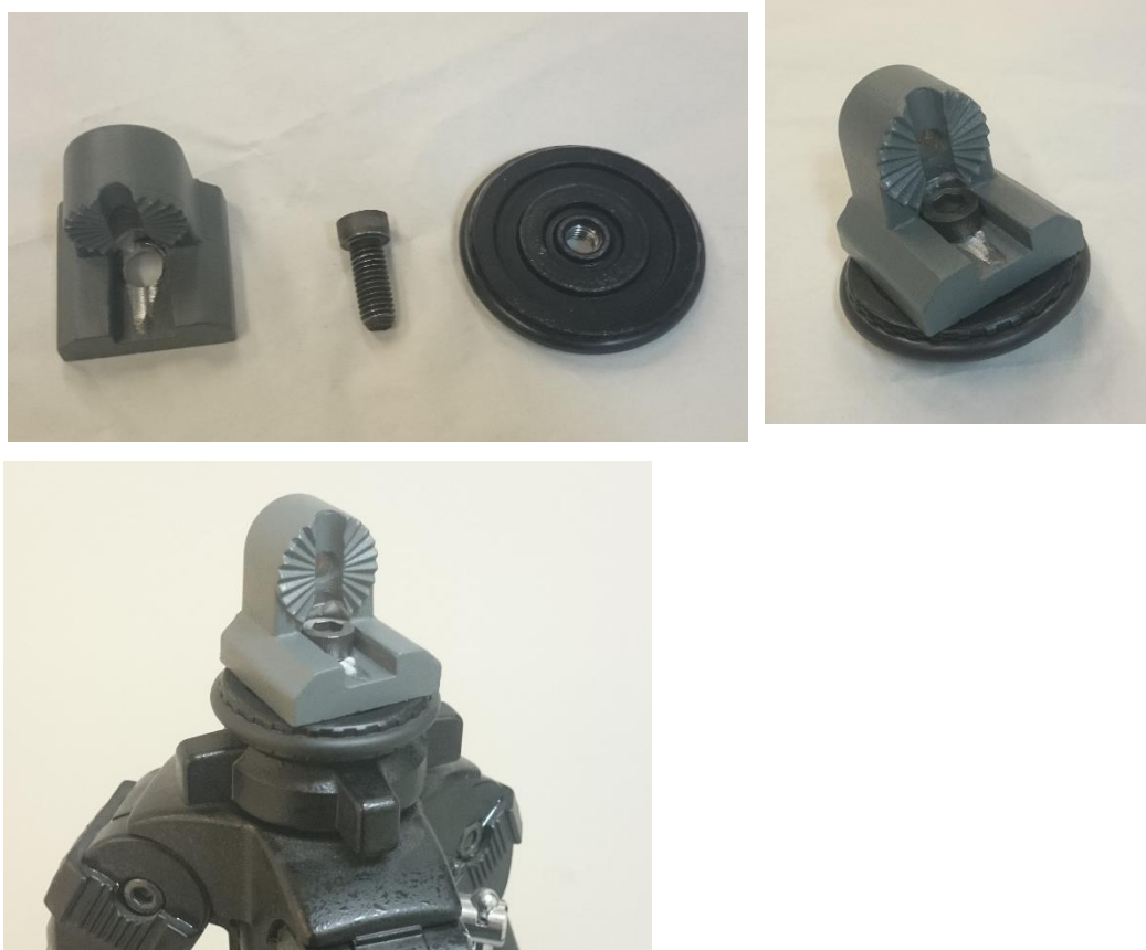
KUVA 23. Tukivarren saranan toinen puolisko kiinnitettynä kolmijalkaan
