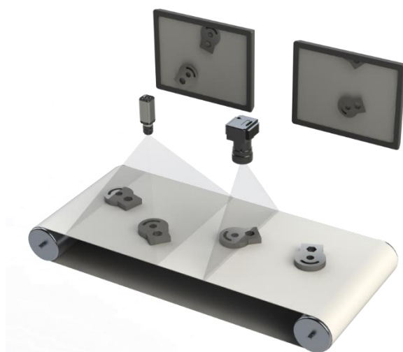
KUVA 1. Vas. Matriisikamera, oik. viivakamera (WWW-sivu SAMK Automaation tutkimusryhmä)
