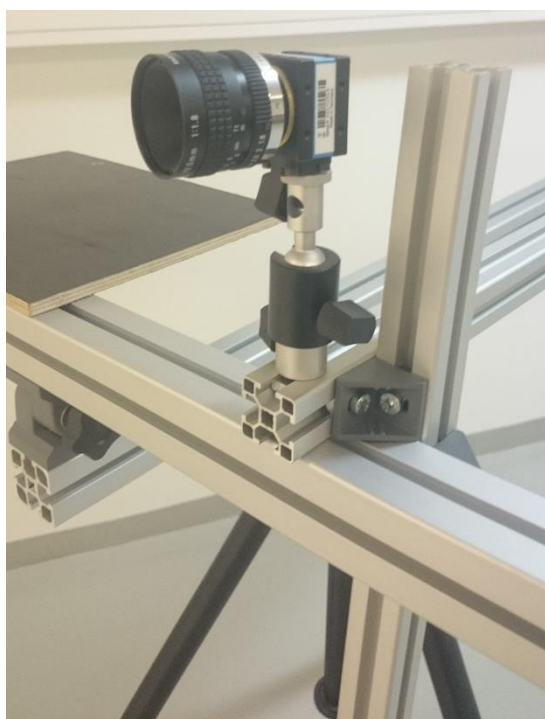
KUVA 26. Kamera kiinnitettyä telineessä olevaan palloniveleen
