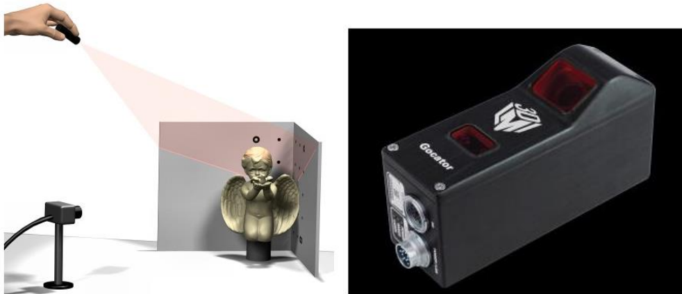
KUVA 15. Vasemmalla viivalaserskannaus, jossa laseria liikutetaan kädellä (David Vision Systems www-sivu 2014), oikealla viivalaser ja kamera integroituna (Vision Systems 2013)
