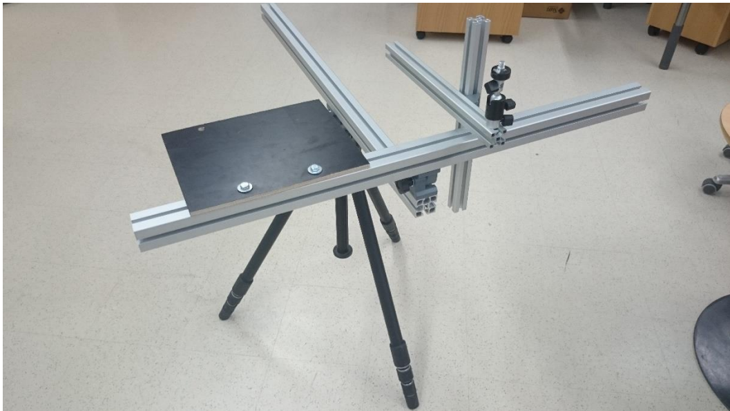
KUVA 19. Valmis teline asennettuna kolmijalkaan
