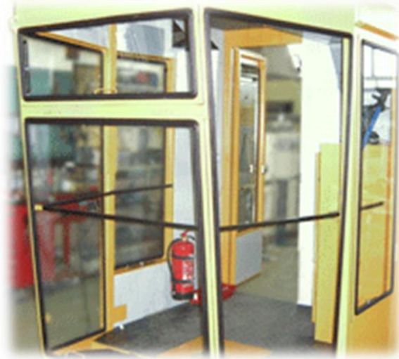
Kuva 3. Työkoneohjaamo (Janavalo Oy 2015)
