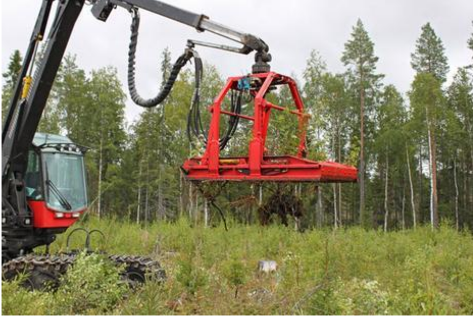
Kuva 2. Pentin Paja Oy:n Naarva P25-kitkentälaite. (Pentin Paja Oy, [viitattu 15.2.2016].)
