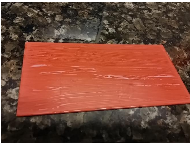
Kuva 18. Näytelevy vahan levityksen jälkeen, ennen kiillotusta.
