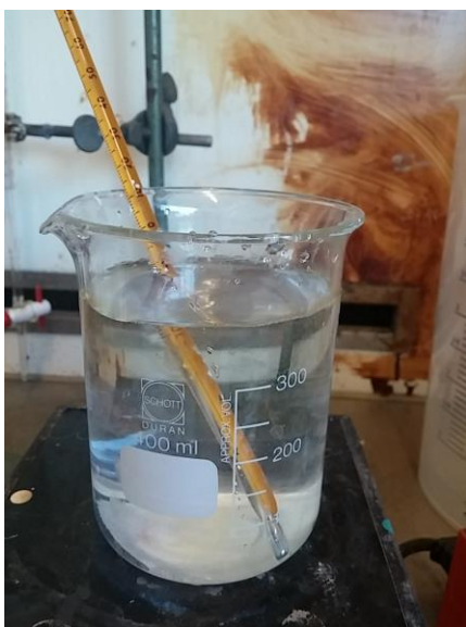
Kuva 17. Vahanpoistoon käytetyn pesuliuksen lämmitystä.
