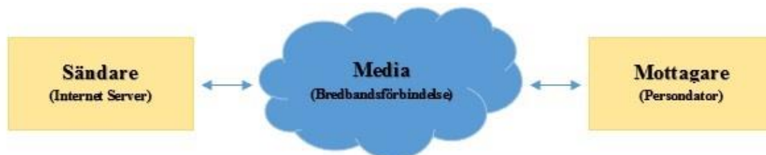
Figur 1 Huvudsakliga komponenter i datakommunikationssystem.
