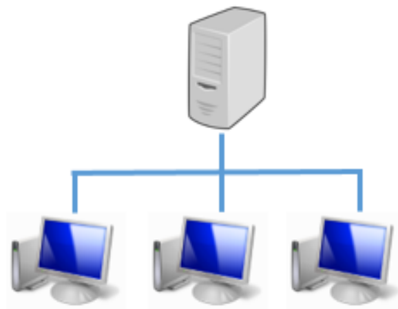
Figur 6 Fysisk sammankoppling av ett bussnät.
