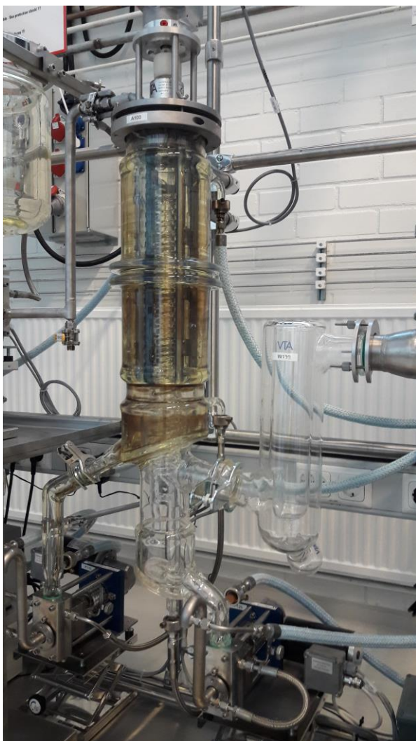
Kuva 11. Ohutkalvohaihduttimen kolonni, jonka pyyhkijä on paikoillaan.
