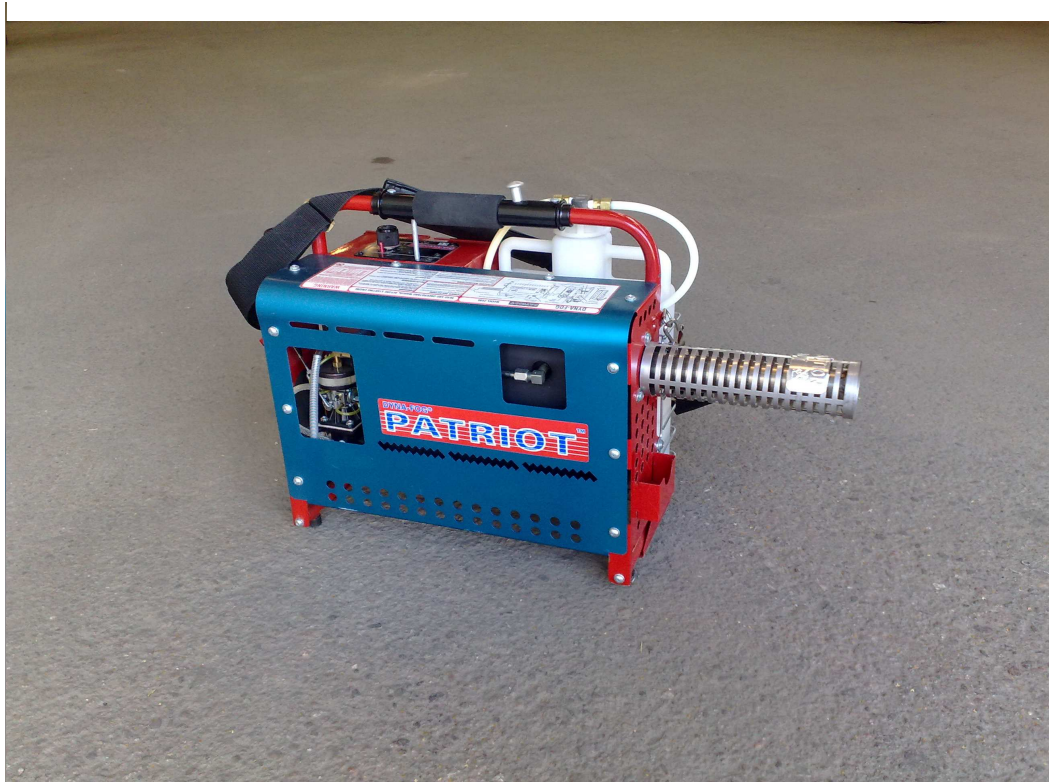
Kuva 1. Trailblazer Patriot. Orgaanisen peroksidin levittämiseen (PF versio).
