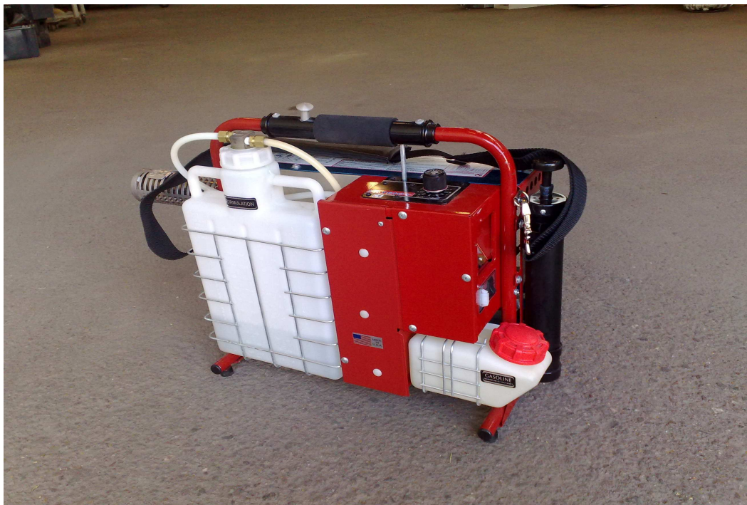
Kuva 2. Trailblazer Patriot. Orgaanisen peroksidin levittämiseen (PF versio).
