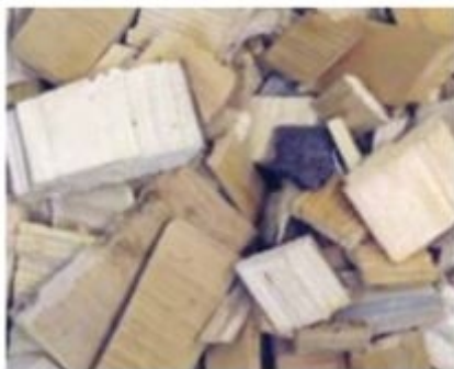
KUVA 8. Kartioruuvihakkurin haketta (kuvaaja: Tanja Lepistö) [11]
