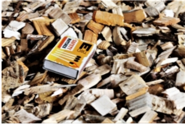
KUVA 4. Laikkahakkurilla tuotettua haketta (kuvaaja: Aarno Pylväs)
