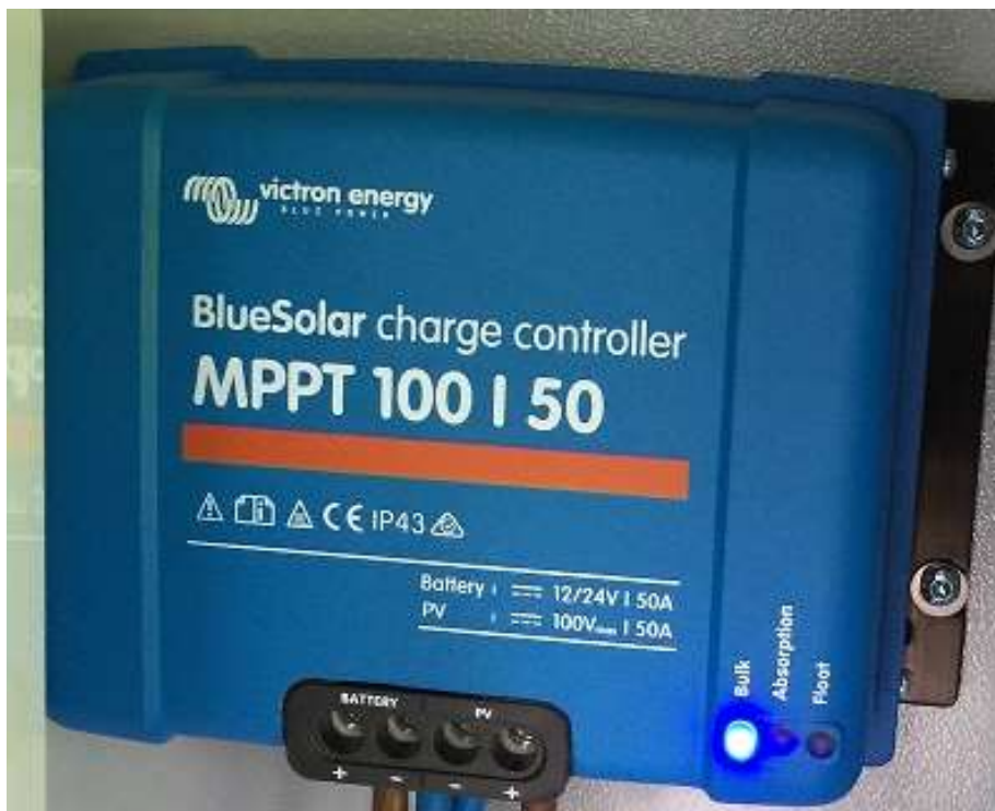
Kuva 5 Victron Energy MPPT 100/50 -säädin (Juuso Rantaniitty)
