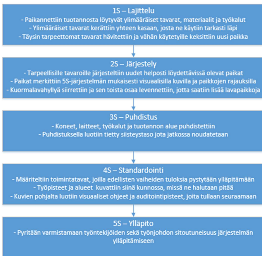
Kuvio 18. 5S-järjestelmän käyttöönoton vaiheet
