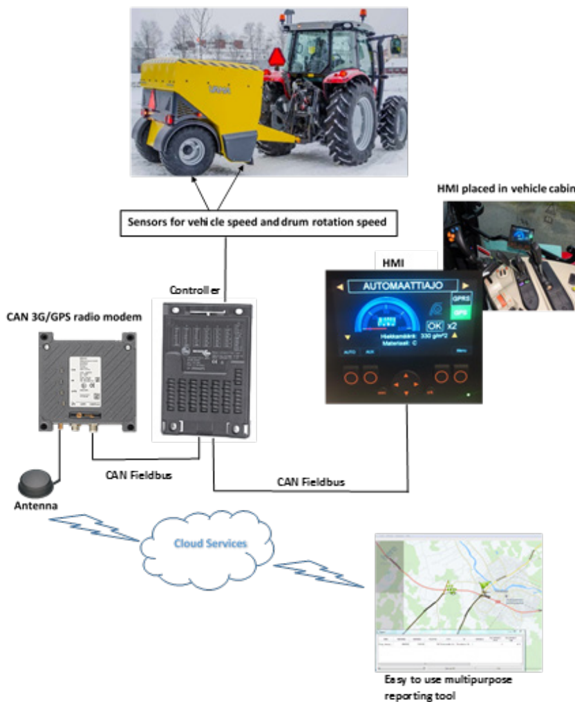
Kuvio 10. Paikkatietoa hyödyntävän tienhoitokoneen demonstraatioissa käytetty toteutusratkaisu.
