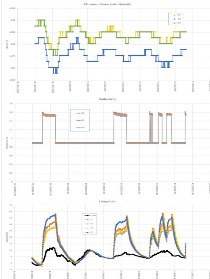
Kuvio 6. Mittaustulokset aikasarjoina: ylhäällä anturijännitteet, keskellä vaihevirrat, alhaalla lämpötilat.
