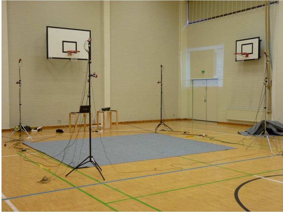
KUVA 24. Liikkeenkaappauslaitteisto asennettuna liikuntasaliin.
