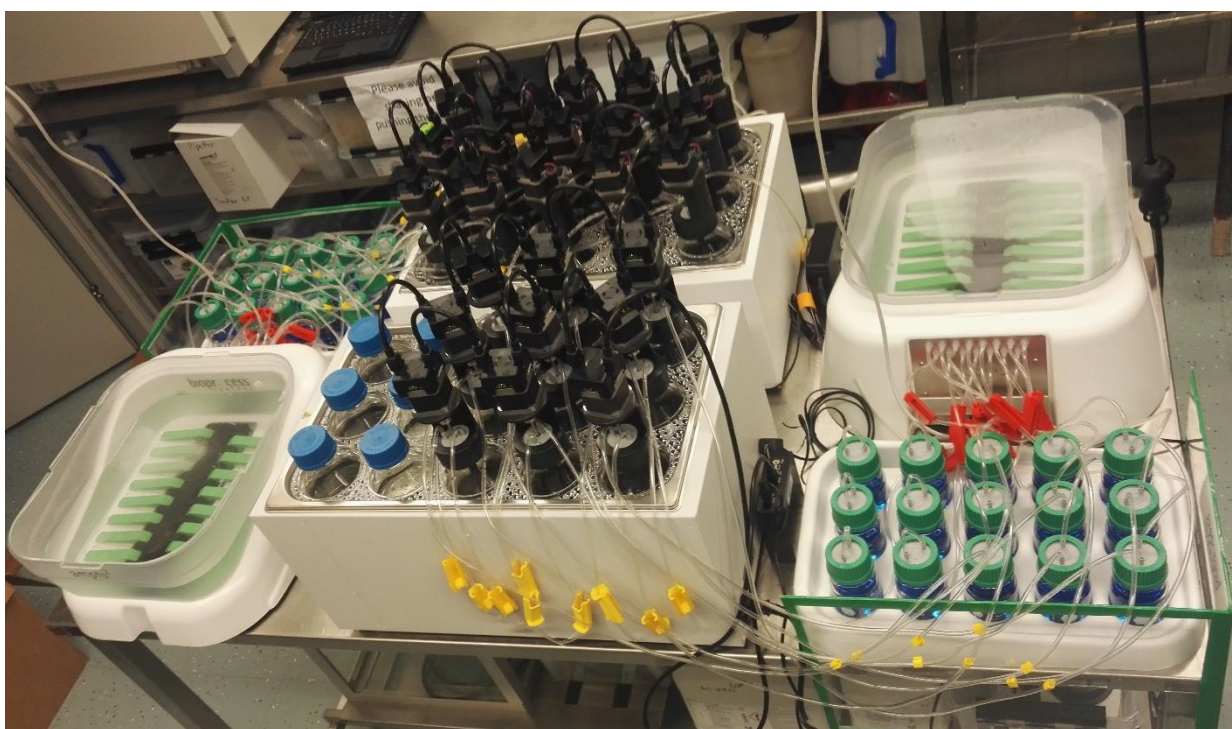
Centrifugerade mikroalger från Sveriges Lanbruksuniversitet, som ska förbehandlas med värme och sedan testas för biogasproduktion.
