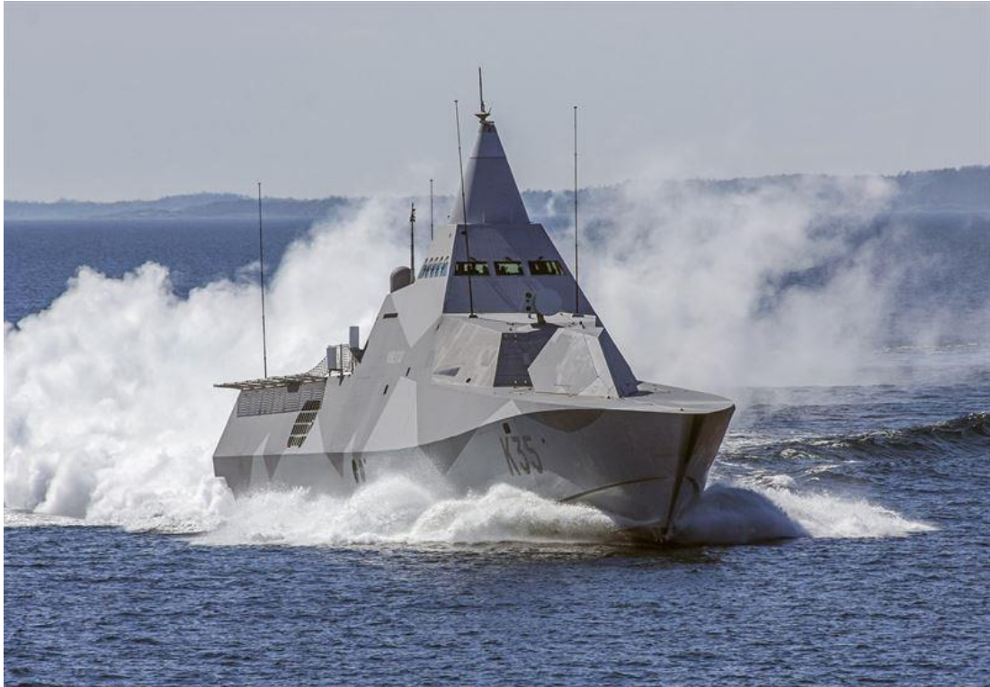
Kuva 4.5 Ruotsalainen Visby- luokan alus, jossa tutkaheijastus on minimoitu rungon muotoilun ja hiilikuidun avulla. [32]
