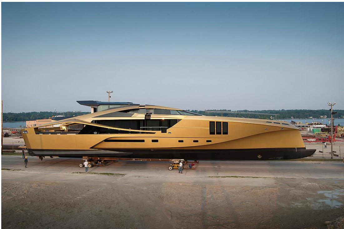
Kuva 4.9 150 jalkainen 48M SuperSport jahti on valmistettu hiilikuitukomposiitista. [29]
