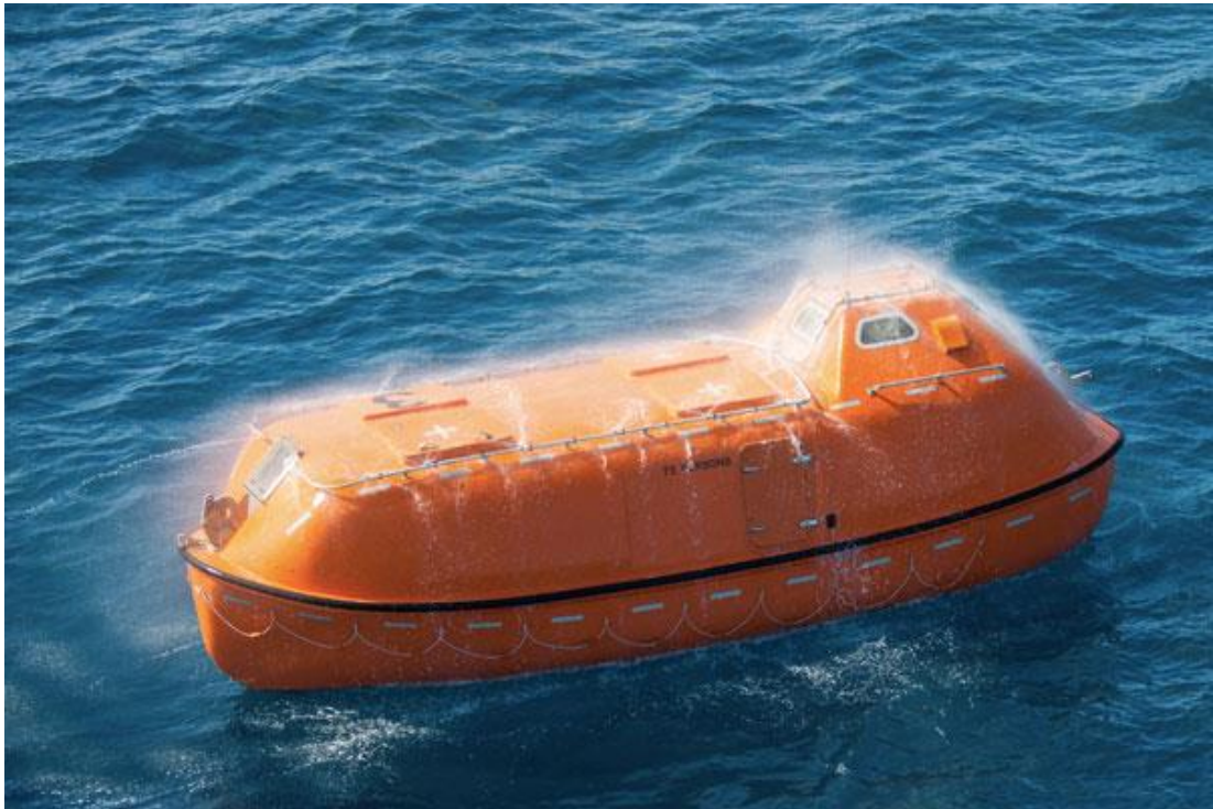
Kuva 4.3 Pelastusveneet ovat olleet jo pitkään lasikuidusta valmistettuja. [28]
