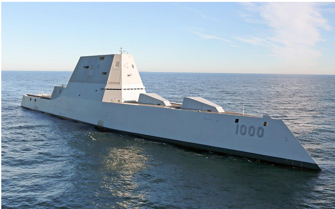
Kuva 4.6 USS Zumwaltin kansirakenteissa pyrittiin maksimoimaan häiveominaisuudet. [31]
