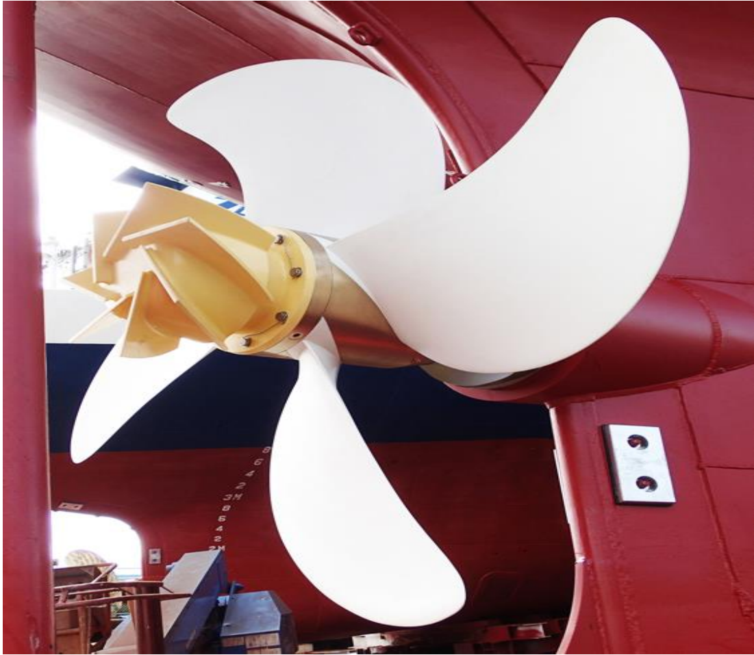
Kuva 4.1 Taiko Maru'un CFRP potkuri asennettuna. [38]
