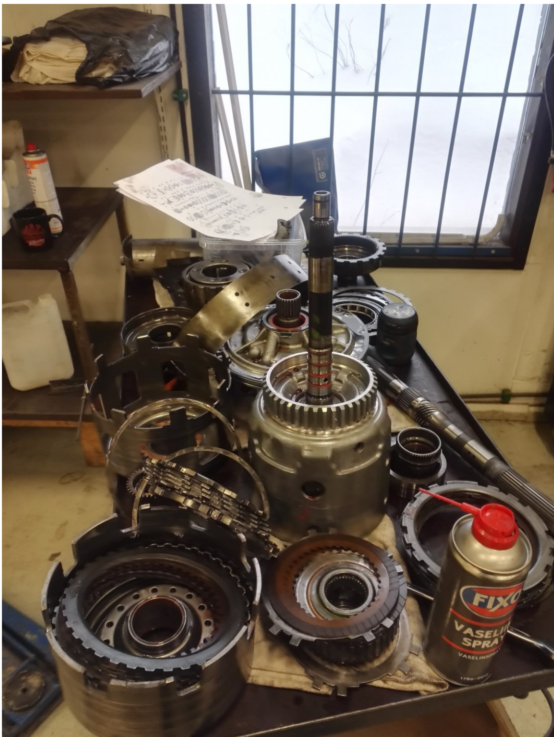
KUVA 9. Vaihteiston kitkalevyt ja kytkinrummut
