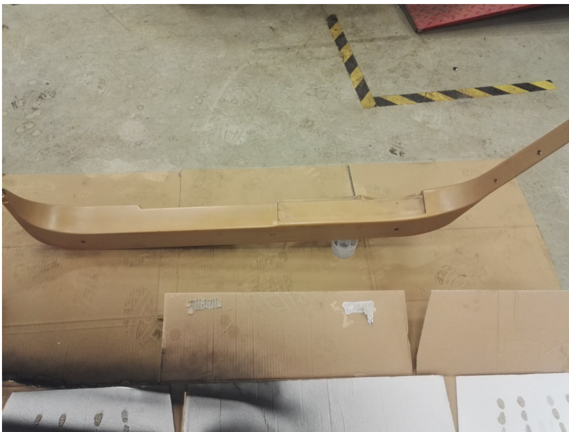
KUVA 12. Hiottu ja pohjustettu matkustajan sivupaneeli.
