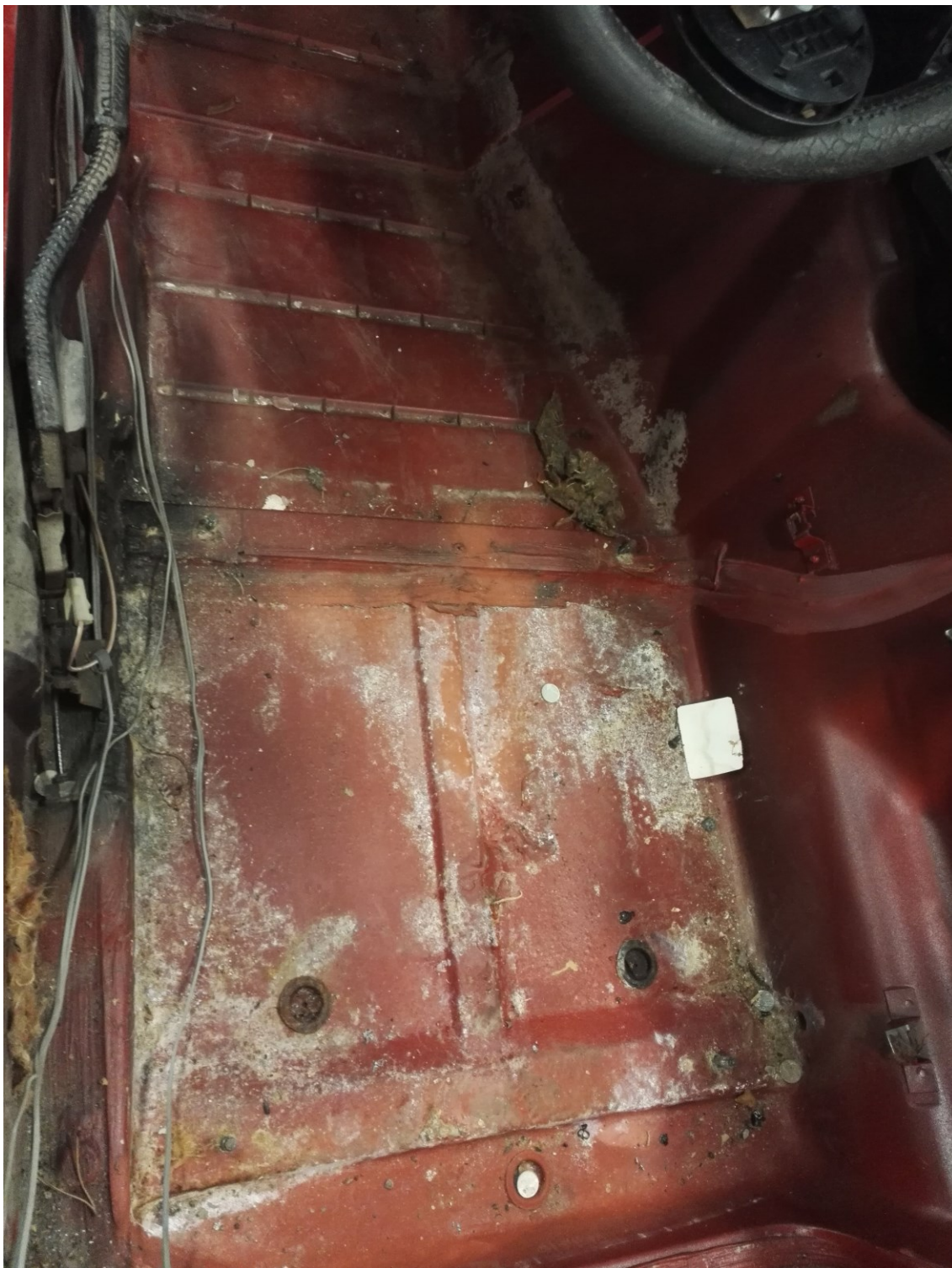
KUVA 8. Hometta kuljettajan tilan verhoilun alla.
