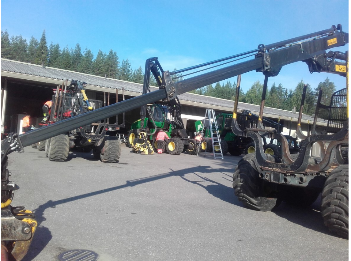
Kuva 18. Hydraulinen puomin jatke piiloletkutuksella
