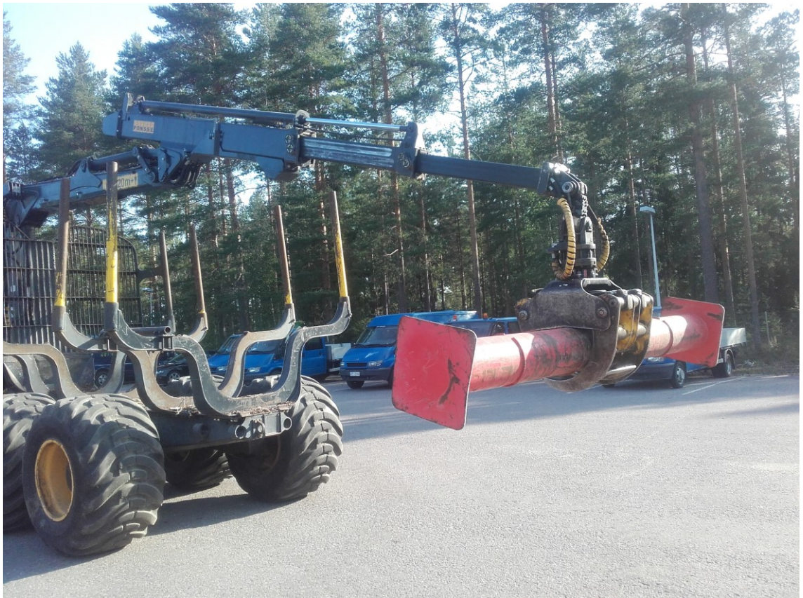
Kuva 22. Puutavarannosturin testaus testipainolla
