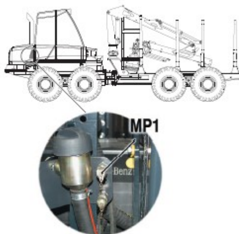
Kuva 26. Ponsse paineenmittausliittimien sijainti (Kuva Ponsse.)
