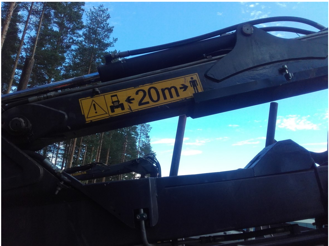
Kuva 10. Puutavaranosturin puomiin kiinnitetty varoitustarra
