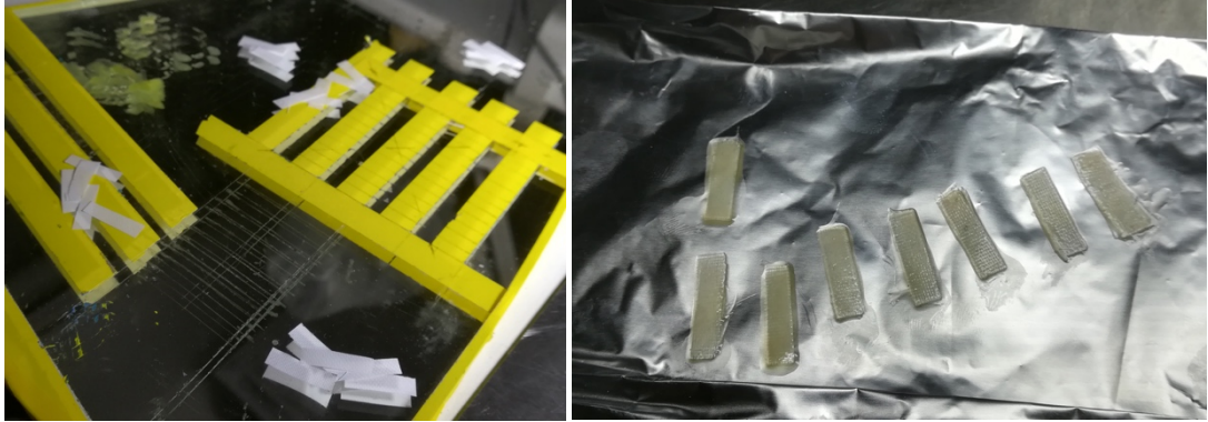
Kuva 5. Tikkujen kuituverkkoja leikattuna ja resini-kostutuksen alkaessa.
