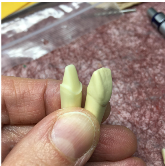
Kuva 4. Kruunu-testikappaleiden mallikruunu ja -pilari.
