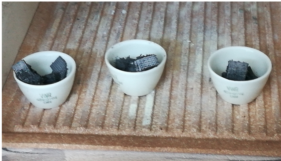
Kuva 2. Fibra Composite Bio-C-materiaalinäytteet poltettiin kuitu-komposiittisuhteen selvittämiseksi.
