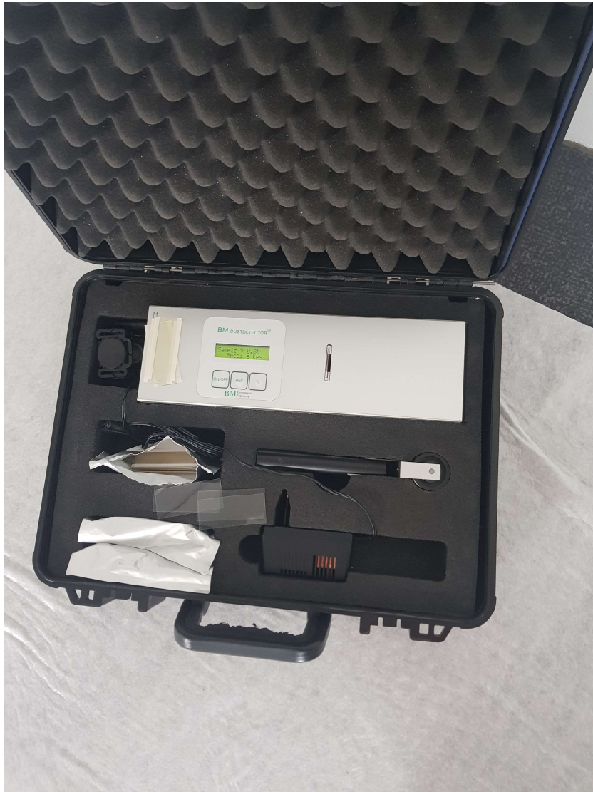
Kuvio 1. BM-Dustdetector, laseroptinen pintapölymittari
