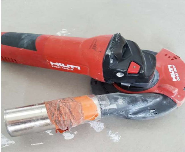
Kuvio 5. Kohdepoistolla varustettu kulmahiomakone
