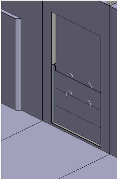
Kuvio 13. Huoltoluukkuun on hyvä asentaa patoesteet.
