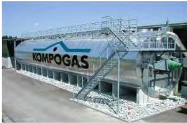
Kuvio 5. Kompogasin vaakamallinen biokaasureaktori (Kutuniva 2012, 53)
