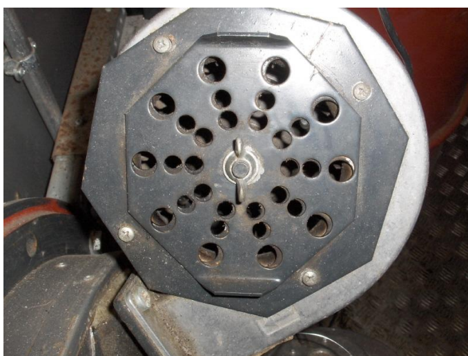
KUVIO 10. Ruokohelven polttokokeissa hyväksi havaittu ensiöilman puhallinsäätö
