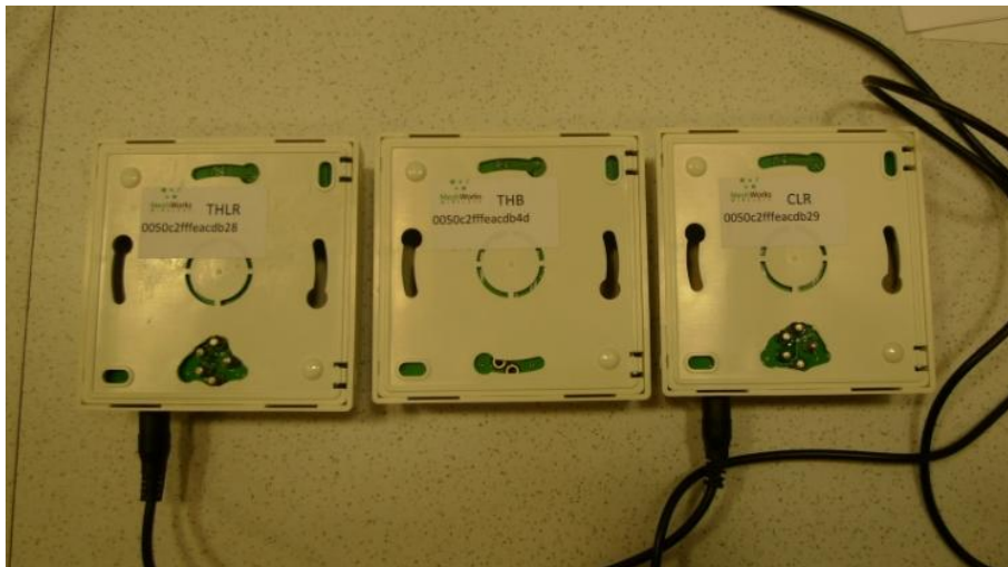
Kuva 5: Vasemmalta oikealle THL-reititin, THB-päätelaite, CLR-reititin
