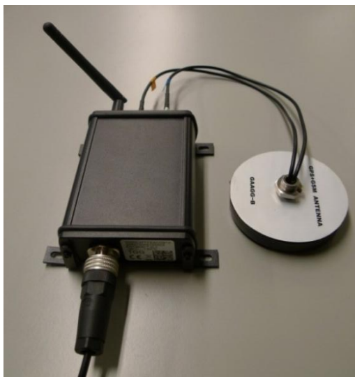
Kuva 4: Gateway-koordinaattori, josta löytyy GPRS- ja GPS-yhteys
