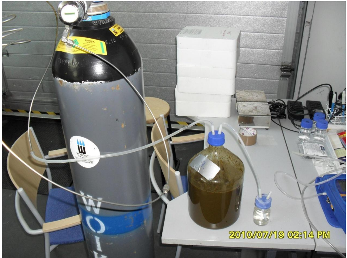
KUVA 13. Koepullojen ja -letkujen tyyppihuuhtelu. Valokuva Jukka Kervinen 2010
