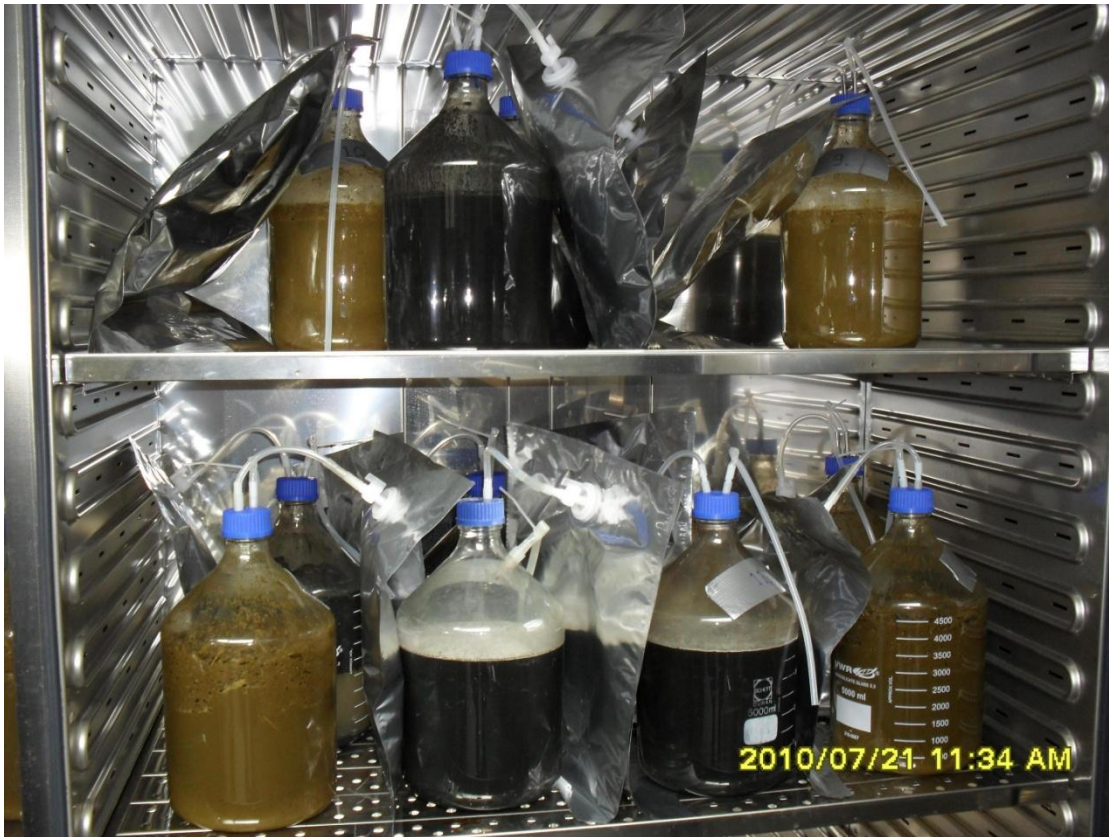
KUVA 14. Panoskoepullot lämpökaapissa. Valokuva Jukka Kervinen 2010
