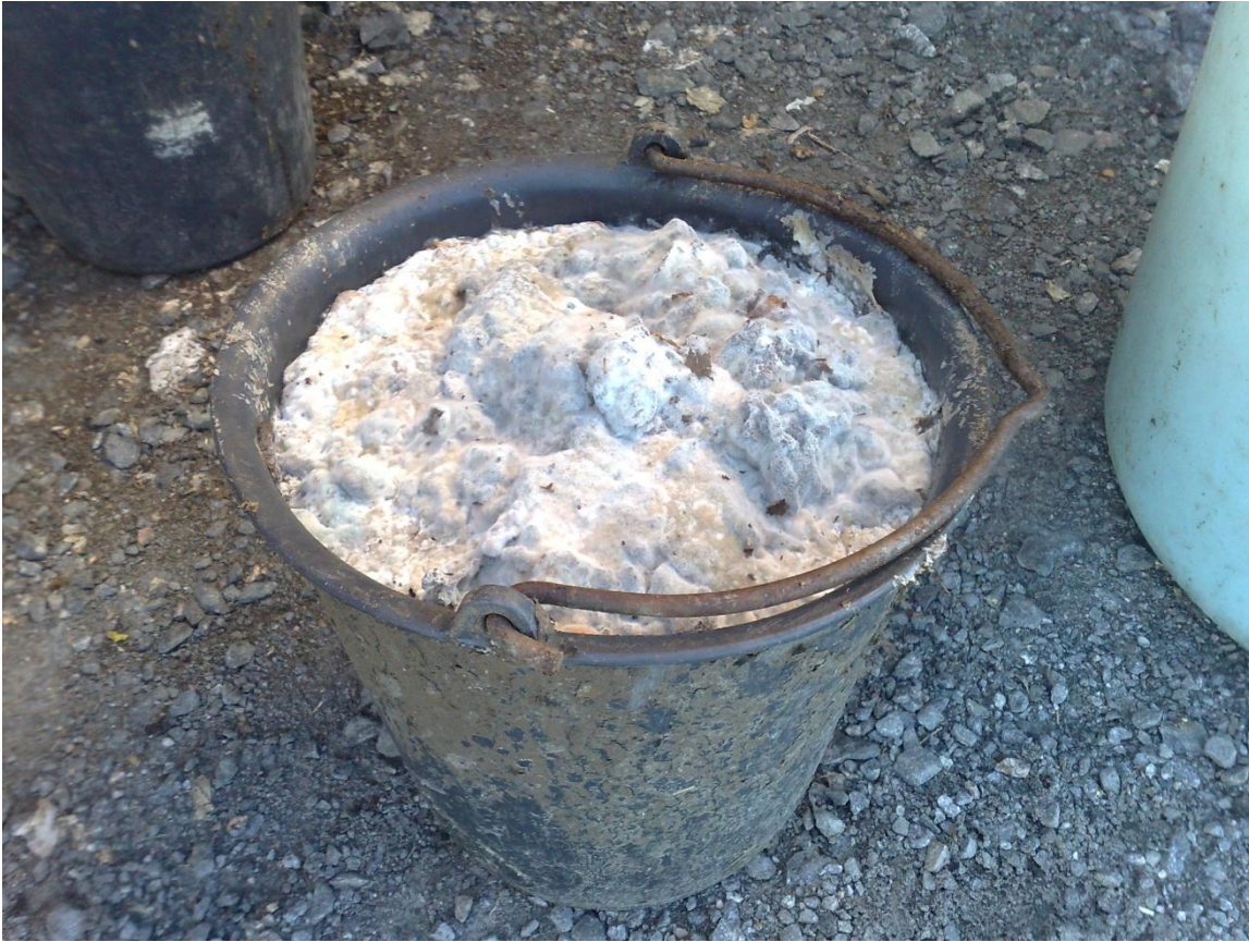
KUVA 12. Biojäte punnittiin sankoihin, jotka olivat muovipusseja helpompia nostaa ruuvikuljettimille. Lämpimässä säilytetyyn biojätteen pinnalle ilmaantui nopeasti homekasvustoa.
