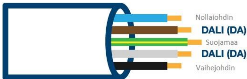
Kuva 1. Havainnollistaminen kaapelista, jossa DALI-väylä ja käyttövirta samassa (TYA670W - KNX/DALI Gateway värilämpötilan säädöllä 2018)
