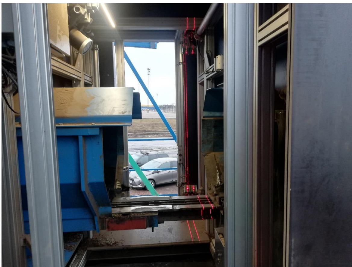
Kuva 5. Näkymä 3D-mittarin sisältä
