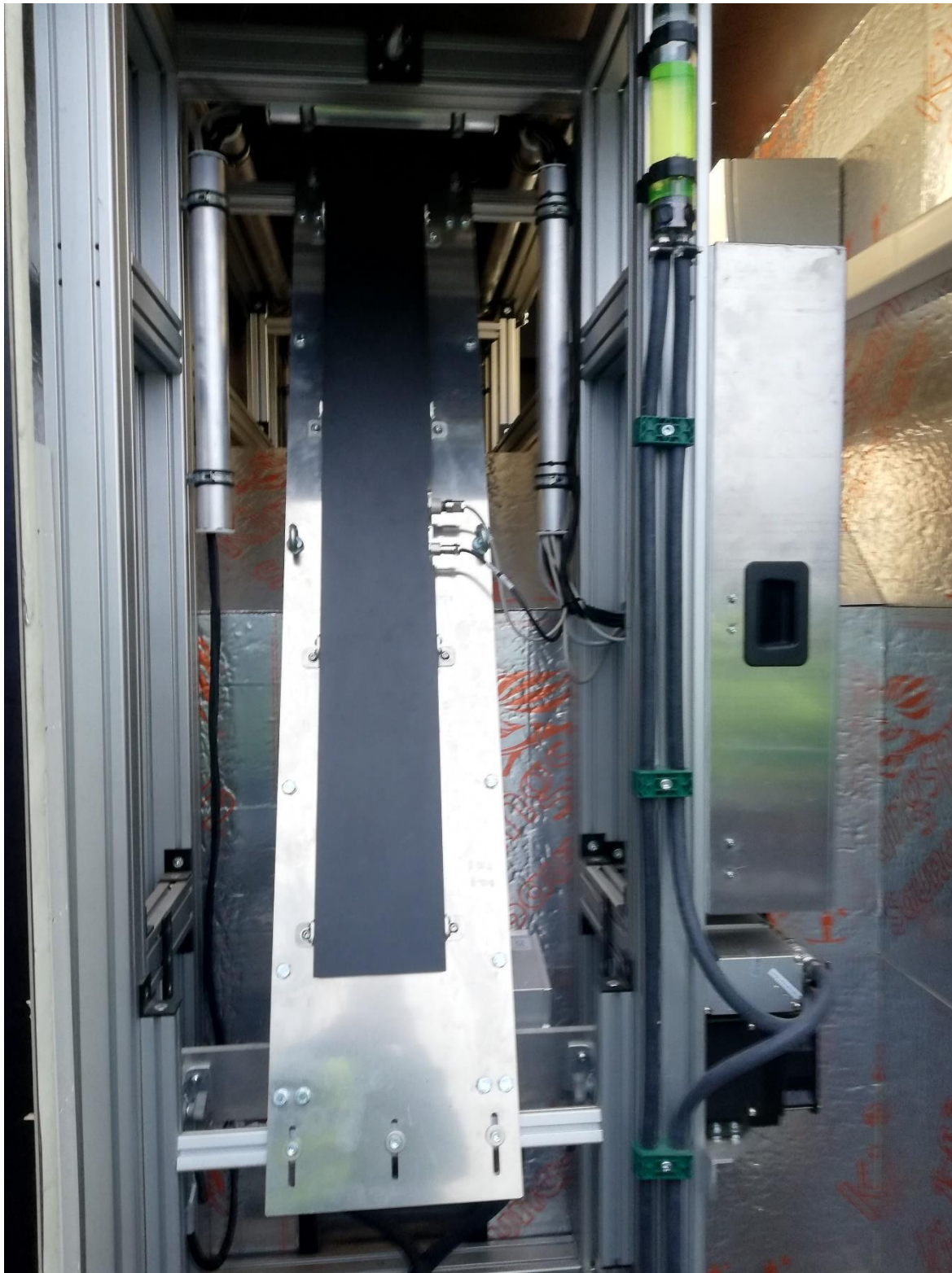
Kuva 6. Näkymä tukkiröntgenin sisältä
