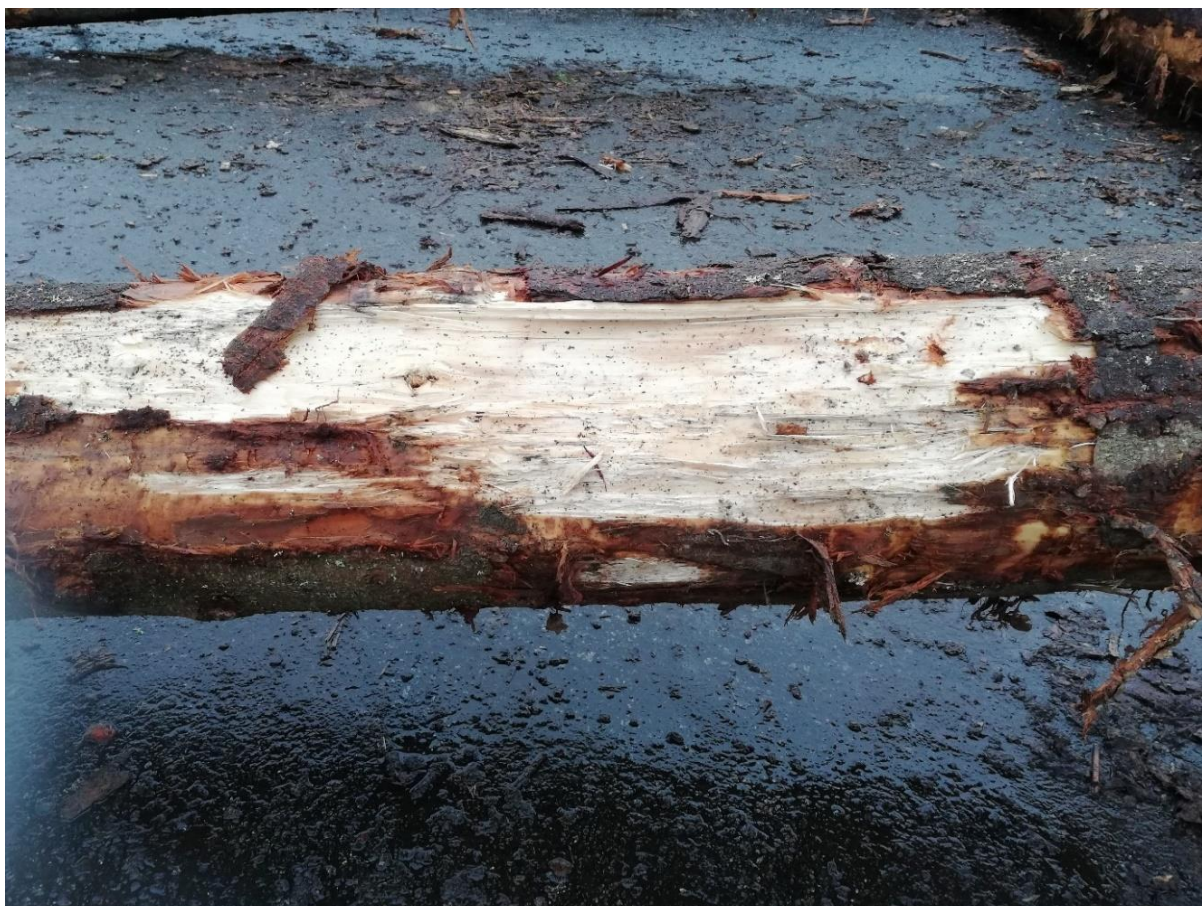
Kuva 8. Esimerkki kuljetuksessa syntyneestä vaurioista
