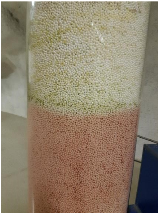
KUVA 11. Polystyreenipallot demo -laitteessa
